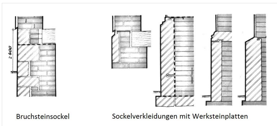
Bild 4-18: Bruchsteinsockel und Sockelverkleidungen mit Werksteinplatten 84
