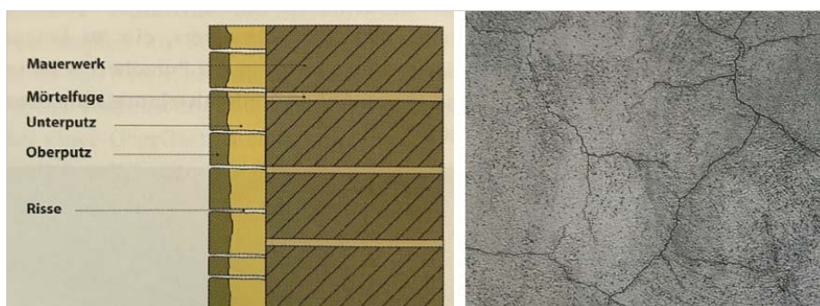
Bild 5-27: Schematische Darstellung und Realaufnahme von Schwindrissen 232
