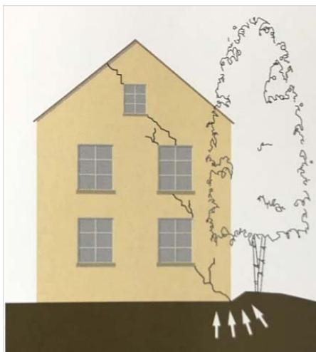
Bild 5-17: Risse durch Baumbestand 214
