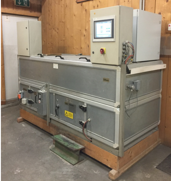
Abbildung 5.5: Trockenofen für die Delaminierungsprüfung (Fa. KLH Massivholz GmbH)
