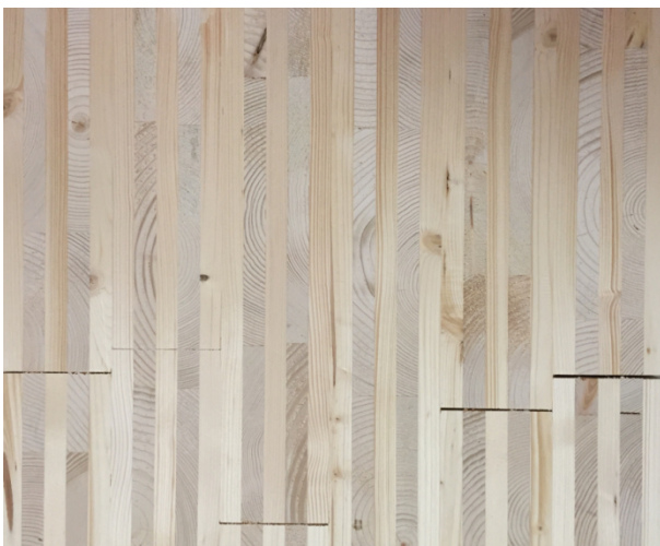
Abbildung 4.13: Offene Fugen und ungünstiges Fugenbild der REX-Querlagen
