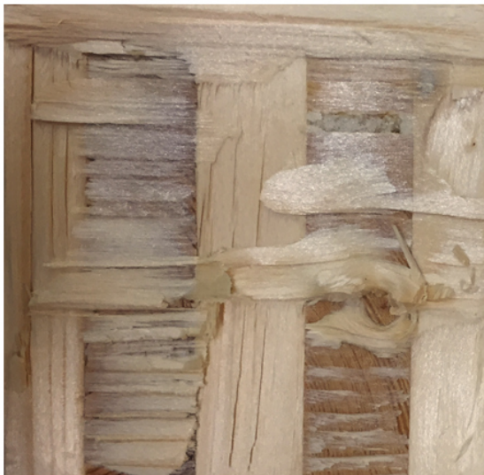
Abbildung 6.3: Ergebnisse der Delaminierungsprüfung von Prüfkörpern der Prüfsérie B
