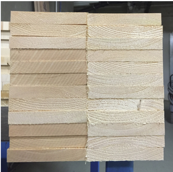
Abbildung 4.3: Längslagenlamellen der BSP-Probekörper
