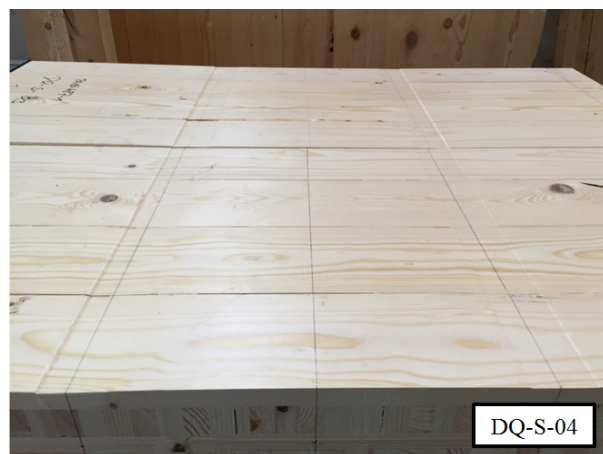
Abbildung 4.29: Bruchbilder mit Rollschubversagen in der Querlage und Schubversagen in der Längslage bei DQ-S-03 und Druckfalten bei DQ-S-04
