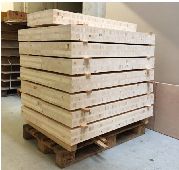
Abbildung 4.27: Prüfkörper für Rollschubprüfung
