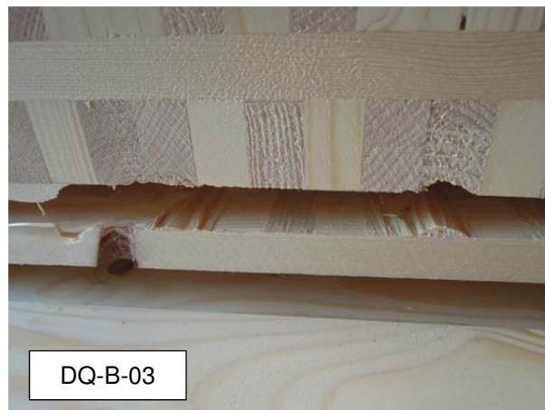
Abbildung 6: Klebeversagen zwischen unterer Decklage (Zugzone) und XML-Lage – deutliche Unterschiede zwischen den Hirnholzbereichen und den Querlagen der XML-Platte in Bezug auf den Klebstofffilm
