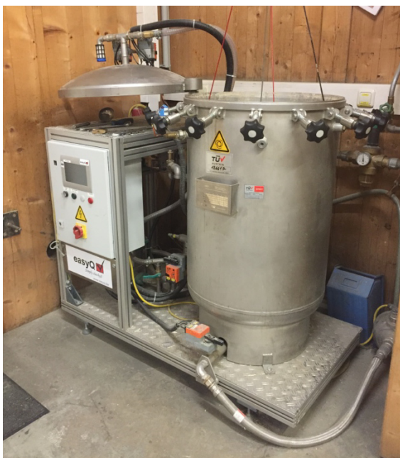
Abbildung 5.4: Druckgefäß für die Delaminierungsprüfung (Fa. KLH Massivholz GmbH)
