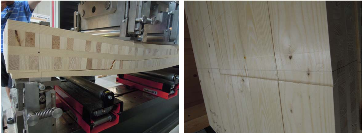
Abbildung 8: Bruchbilder der Probe DQ-S – Rollschubversagen der XML-Querlage (li); Beispiel einer Druckfalte (re)
