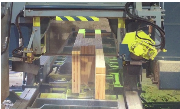
Abbildung 3.7: Auftrennung der BSP-Ausschnitte mittels Horizontalbandsäge
