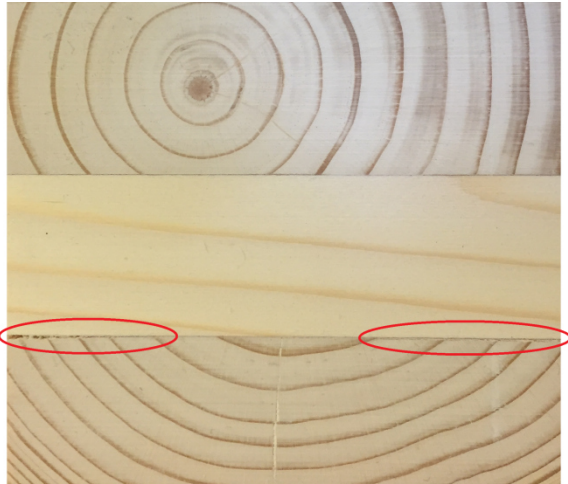
Abbildung 5.3: Delaminierung eines BSP-Prüfkörpers ohne Delaminierungsprüfung
