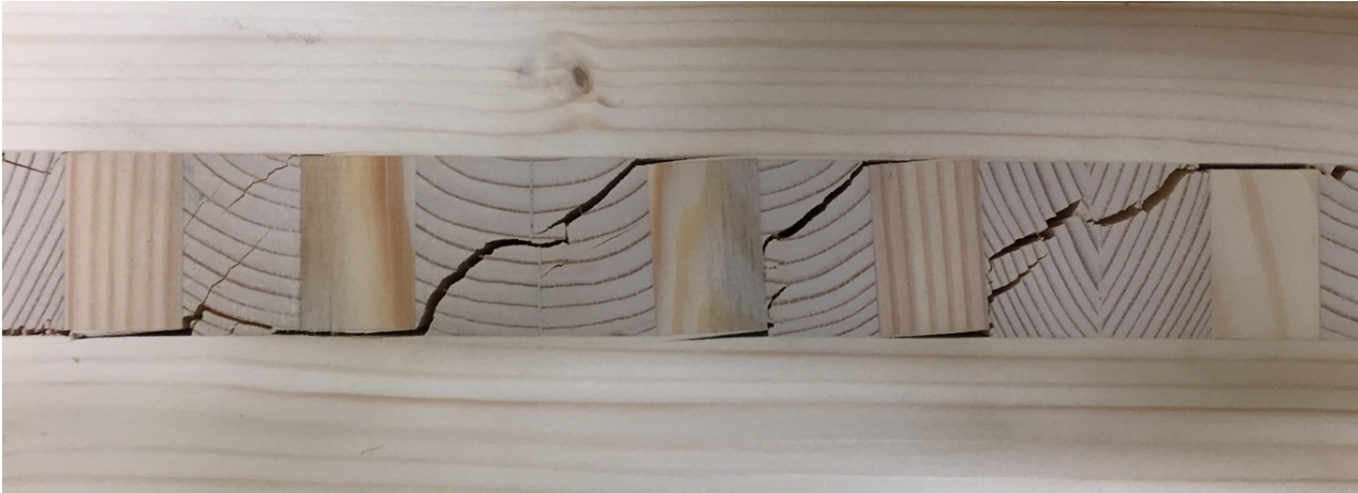
Abbildung 4.32: Stützeffekt der Hirnholzlagen bei Rollschubbeanspruchung
