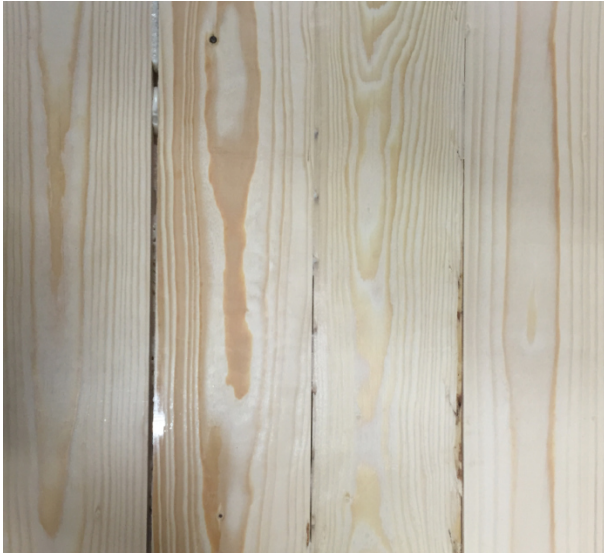
Abbildung 4.12: Große Fugen zwischen den Längslagen durch fehlende Schmalseitenverklebung
