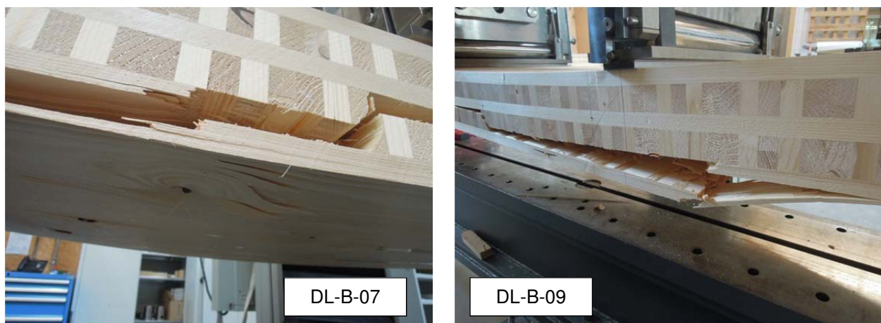
Abbildung 5: Bruchbild mit Klebeversagen zwischen unterer Querlage (XML) und Mittellage sowie Bruchbild mit Klebeversagen zwischen unterer Decklage und Querlage – DL-B-07 und DL-B-09
