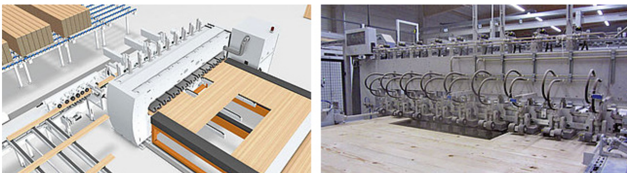
Abbildung 2.22: Auslassen von Öffnungen bei der Herstellung von BSP (Plackner, 2017)
