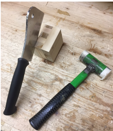
Abbildung 5.6: Metallkeil und Hammer für die Delaminierungsprüfung (Fa. KLH Massivholz GmbH)
