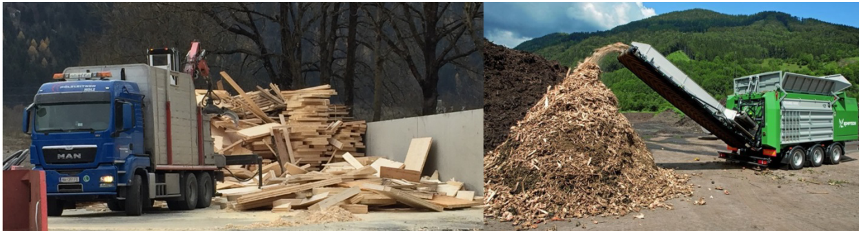
Abbildung 2.21: Zerkleinerung von BSP-Ausschnitten. Links (KLH Massivholz GmbH), rechts (White Skip, 2017)
