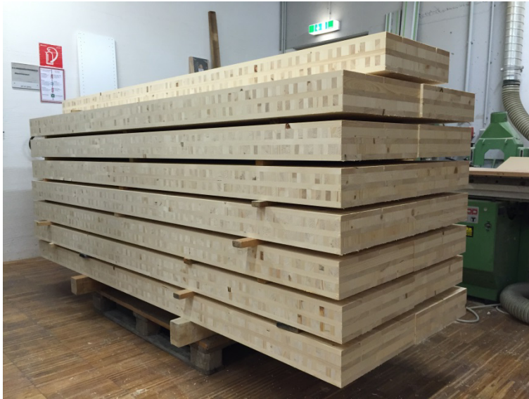
Abbildung 4.22: Prüfkörper der Biegeprüfserie
