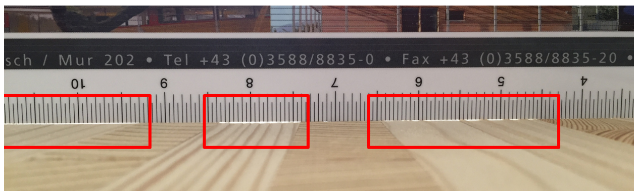
Abbildung 5.16: Formänderung bei REX-Querlagen aufgrund von unterschiedlichem Schwind- und Quellverhalten
