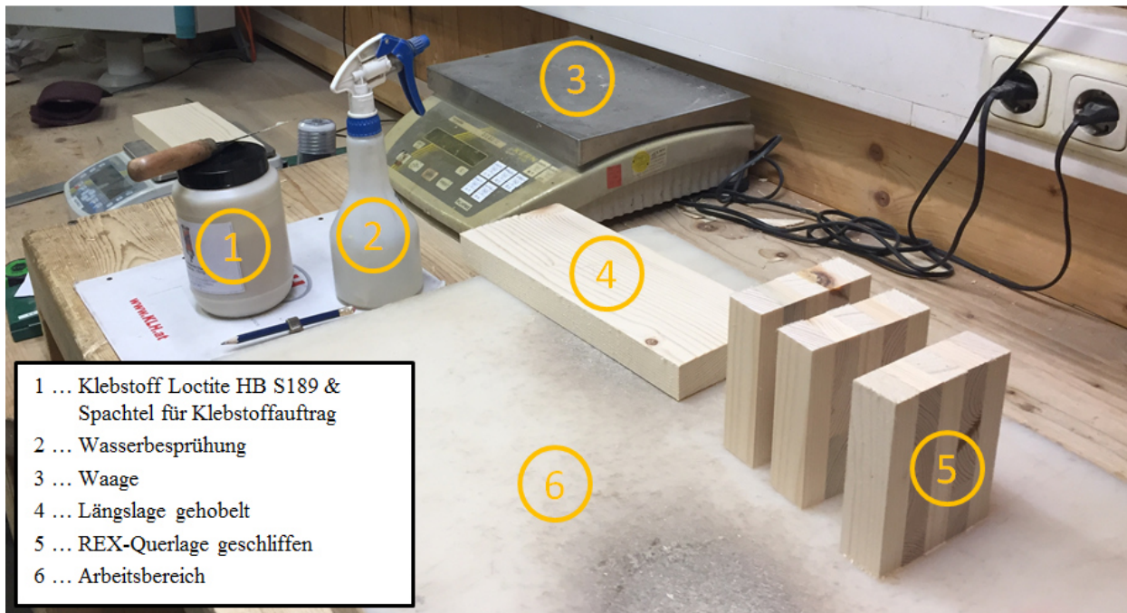
Abbildung 5.21: Verklebung der Prüfkörper von Prüfserie B
