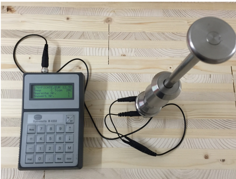
Abbildung 4.6: Überprüfung der Holzfeuchte mittels Hydromette M 2050 (elektr. Widerstandsmessverfahren)
