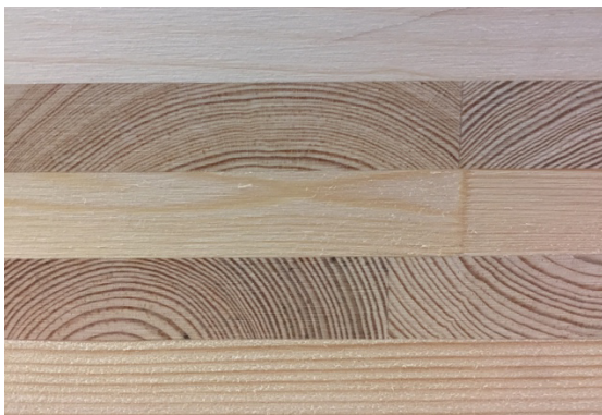
Abbildung 5.18: Oberflächenbeschaffenheit einer geschliffenen REX-Platte
