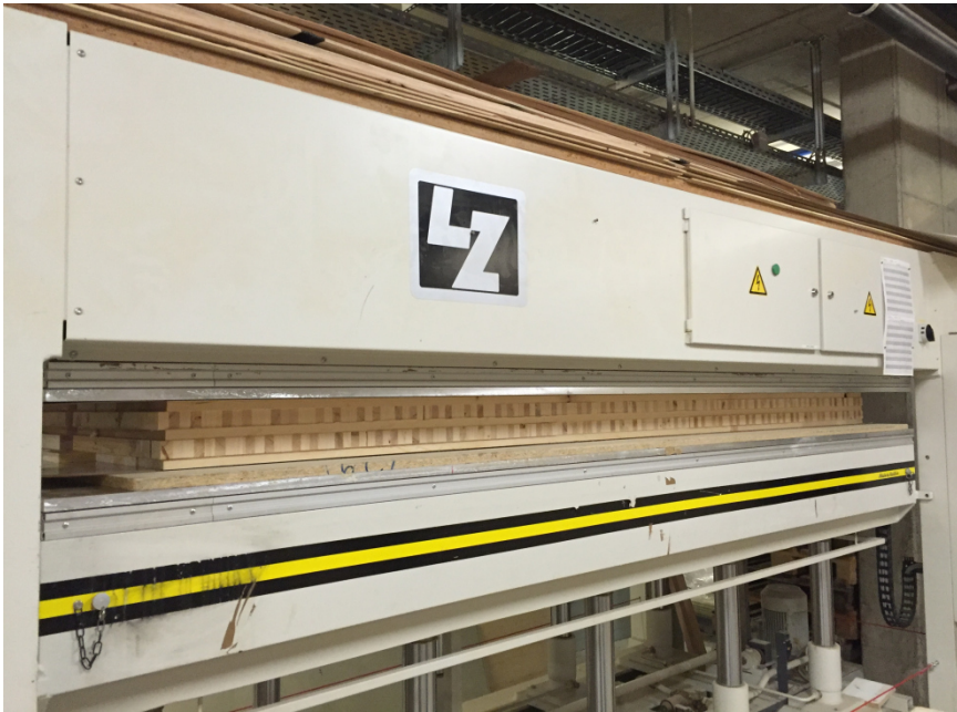
Abbildung 4.9: Verpressung der BSP-Probekörper
