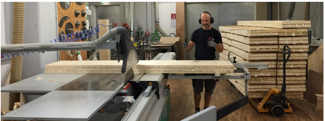
Abbildung 4.10: Längenzuschnitt der BSP-Probekörper
