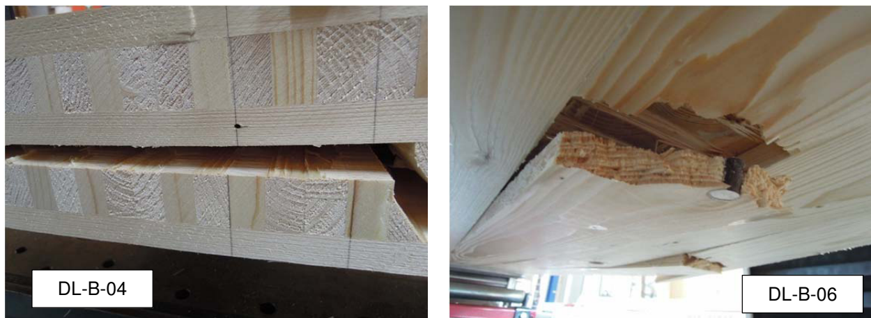
Abbildung 4: Bruchbild mit Klebeversagen zwischen unterer Querlage (XML) und Mittellage sowie Bruchbild mit Klebeversagen zwischen unterer Decklage und Querlage – DL-B-04 und DL-B-06
