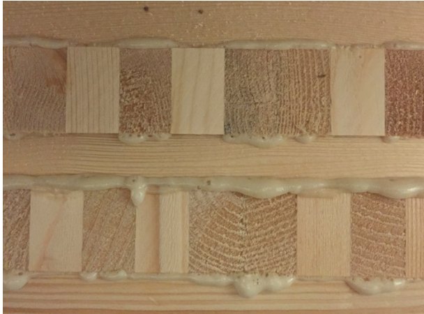
Abbildung 4.14: Hoher Klebstoffaustritt bei einem BSP-Element
