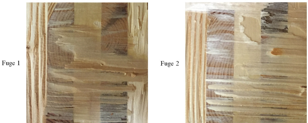
Abbildung 5.24: Delaminierungsanteil am aufgespaltenen Prüfkörper 48 der Prüfserie B
