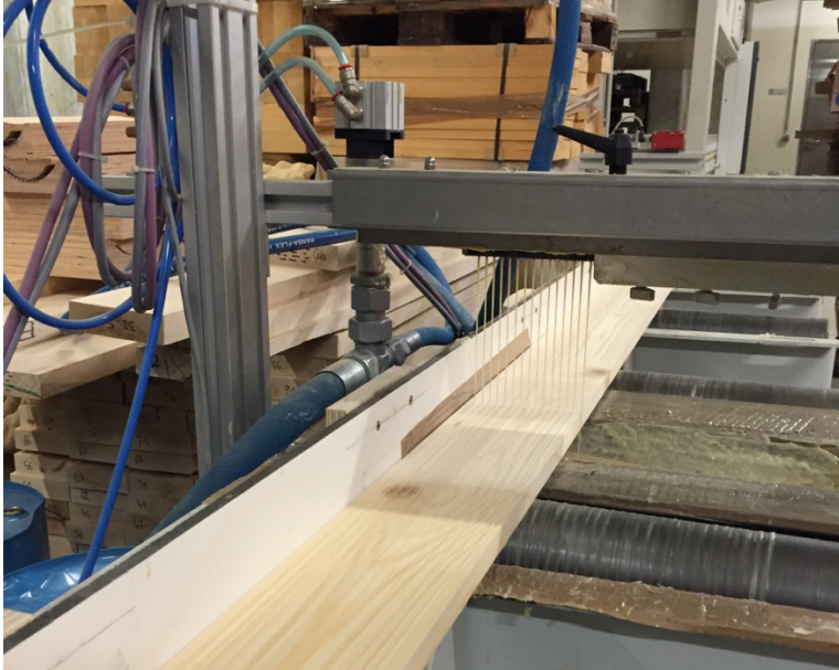
Abbildung 4.7: Klebstoffauftrag der Längslagen
