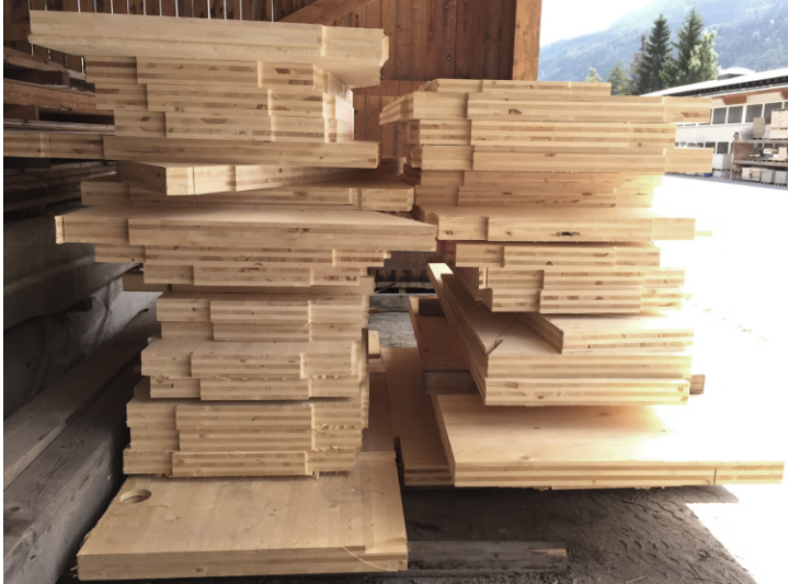
Abbildung 3.6: BSP-Ausschnitte, getrennt nach ihrem Plattenaufbau
