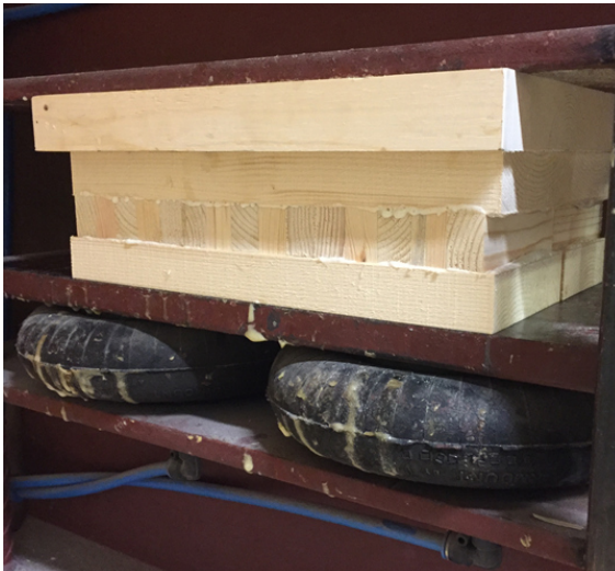
Abbildung 5.22: Verpressung der Prüfkörper von Prüfserie B
