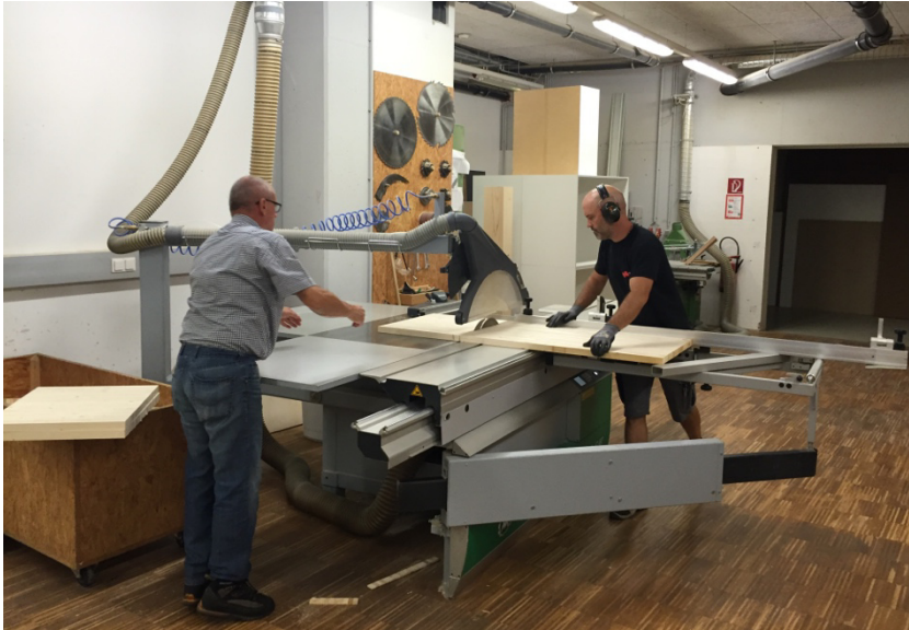
Abbildung 4.5: Plattenzuschnitt der REX-Querlage
