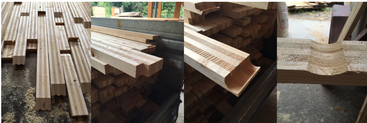
Abbildung 3.10: Fehlstellen von aufgetrennten BSP-Ausschnitten
