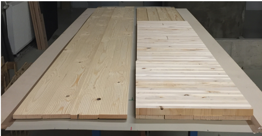
Abbildung 4.8: Flächenverklebung zu BSP-Platten
