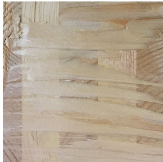
Abbildung 6.3: Ergebnisse der Delaminierungsprüfung von Prüfkörpern der Prüfsérie B
