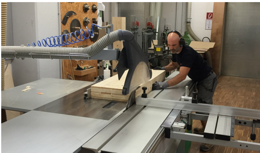
Abbildung 4.11: Breitenzuschnitt der BSP-Prüfkörper
