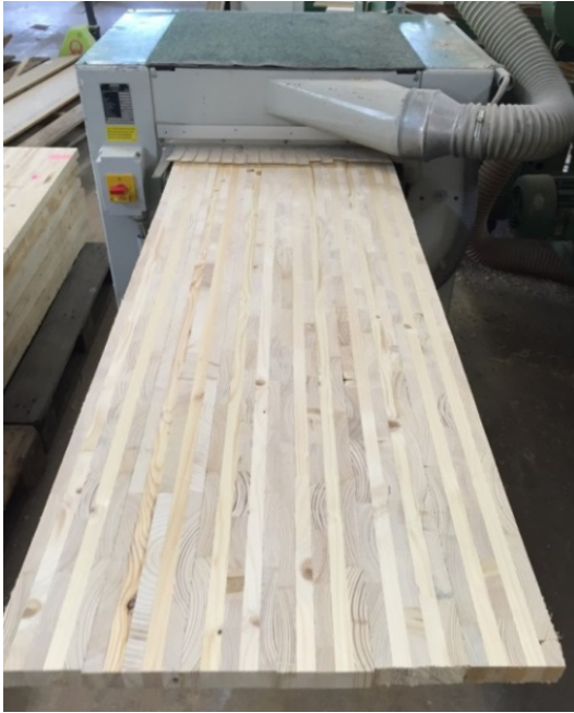
Abbildung 3.13: Oberflächenbearbeitung mittels Dickenhobelmaschine
