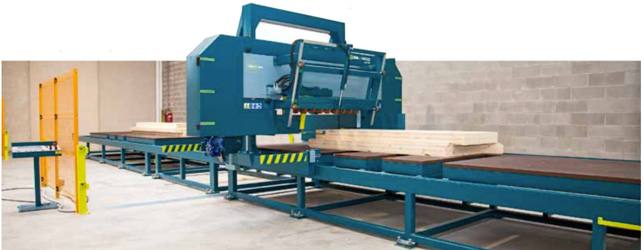
Abbildung 2.23: Auftrennung von BSP-Ausschnitten mittels Blockbandsäge (Holzkurier, 2013 S. 30)
