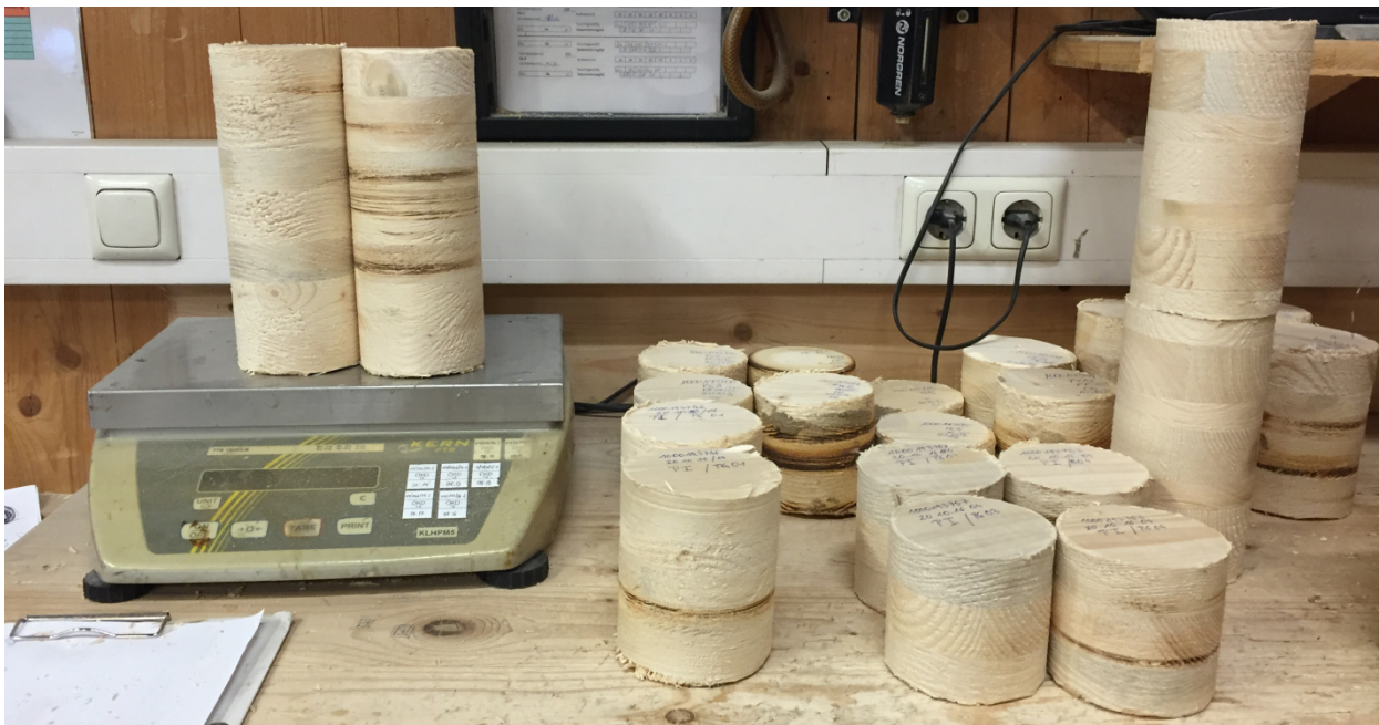
Abbildung 5.7: Prüfkörper für die Delaminierungsprüfung gemäß ÖNORM EN 16351:2015 (Fa. KLH Massivholz GmbH)
