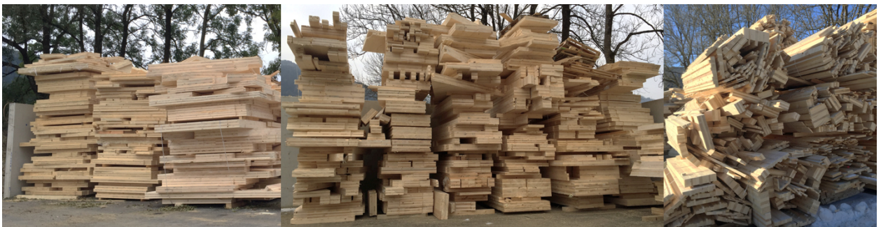
Abbildung 2.18: Lagerung von BSP-Ausschnitten (Fa. KLH Massivholz GmbH)
