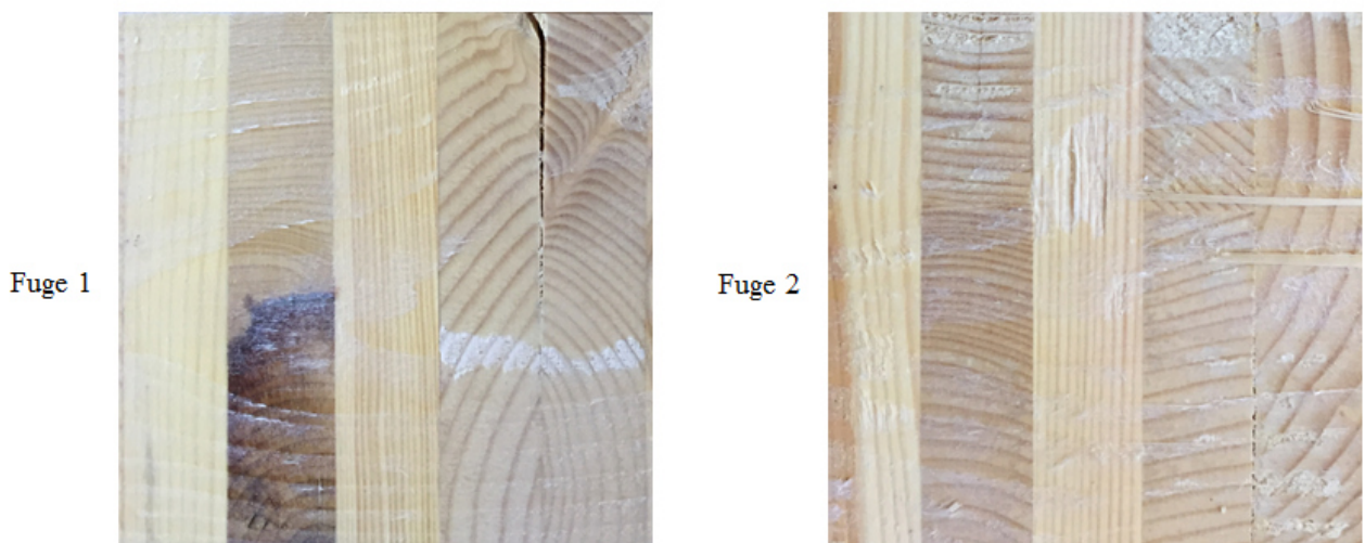
Abbildung 5.11: Delaminierungsanteil am aufgespaltenen Prüfkörper DQ-B-05 der Prüfserie A – Fuge 1 und 2
