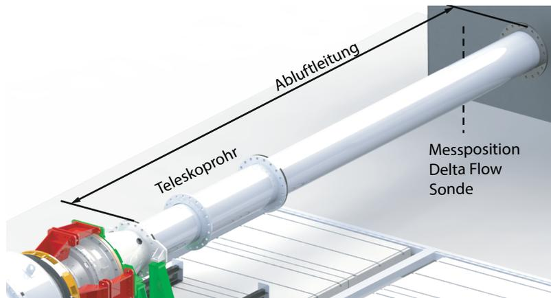
Abbildung 5.16: Abluftführung des Ringgitterprüfstandes
