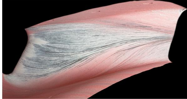
c.) innere Kanalfwand TCF - Ansicht F.L.A. - Hufeisenwirbelbildung und Formierung der IGV Strahlen
