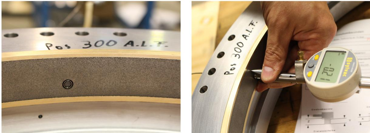
Abbildung 6.16: Vermessung des Sondenrückstandes im Rotorgehäuse mittels Messuhr
