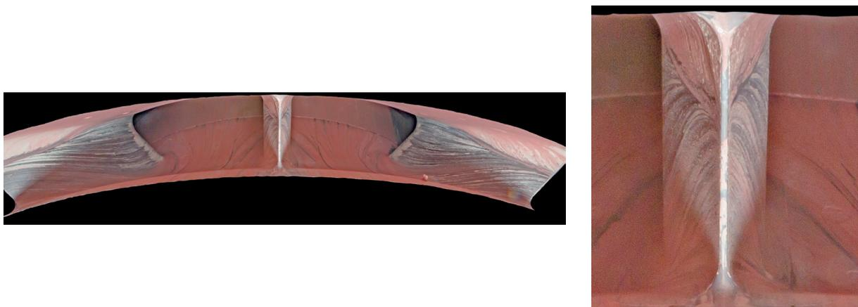
Abbildung 7.5: Abbild des Ölanstriches in zwei TCF Passagen sowie eine Vergrößerung der Hinterkante, bei ungestörter Zuströmung
