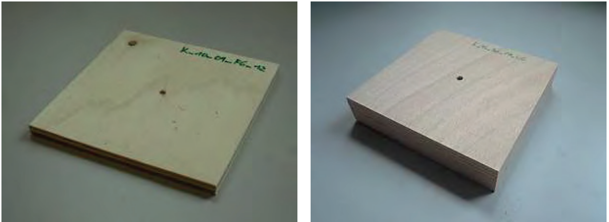
Abbildung 4-12: 9 mm BSPH Fichte der Prüfserien F6 und F7 (li) sowie 30 mm BSPH Buche der Prüfserien P7 und I8 (re)
