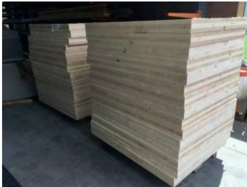
Abbildung 5-8: Basiselemente aus BSP für die Schraubpressverklebung zur Durchführung von Scherprüfungen
