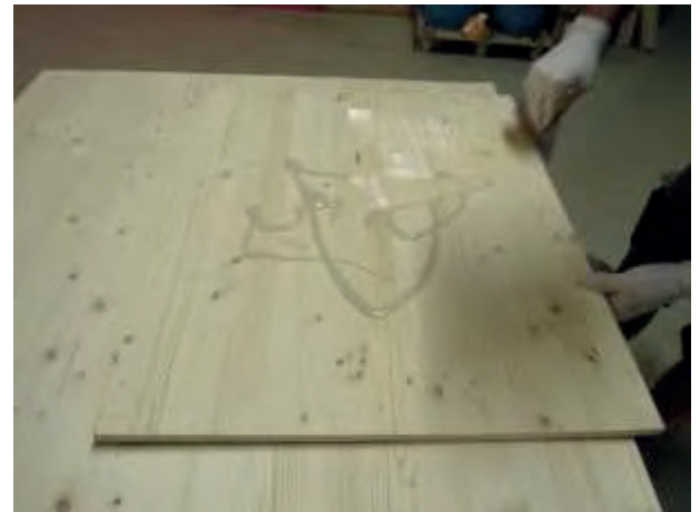
Abbildung 5-9: Klebstoffauftragsmenge mit Waage bestimmt (li), anschließend gleichmäßige Verteilung des Klebstoffs mit geeigneter Spachtel (re)
