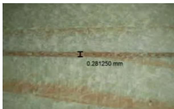
Abbildung 5-28: Bild der elektronischen Mikroskopkamera zur Bestimmung der Klebefugendicke
