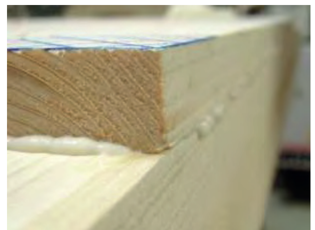
Abbildung 5-11: Austritt des Klebstoffs unmittelbar nach Aufbringung des Schraubenpressdrucks
