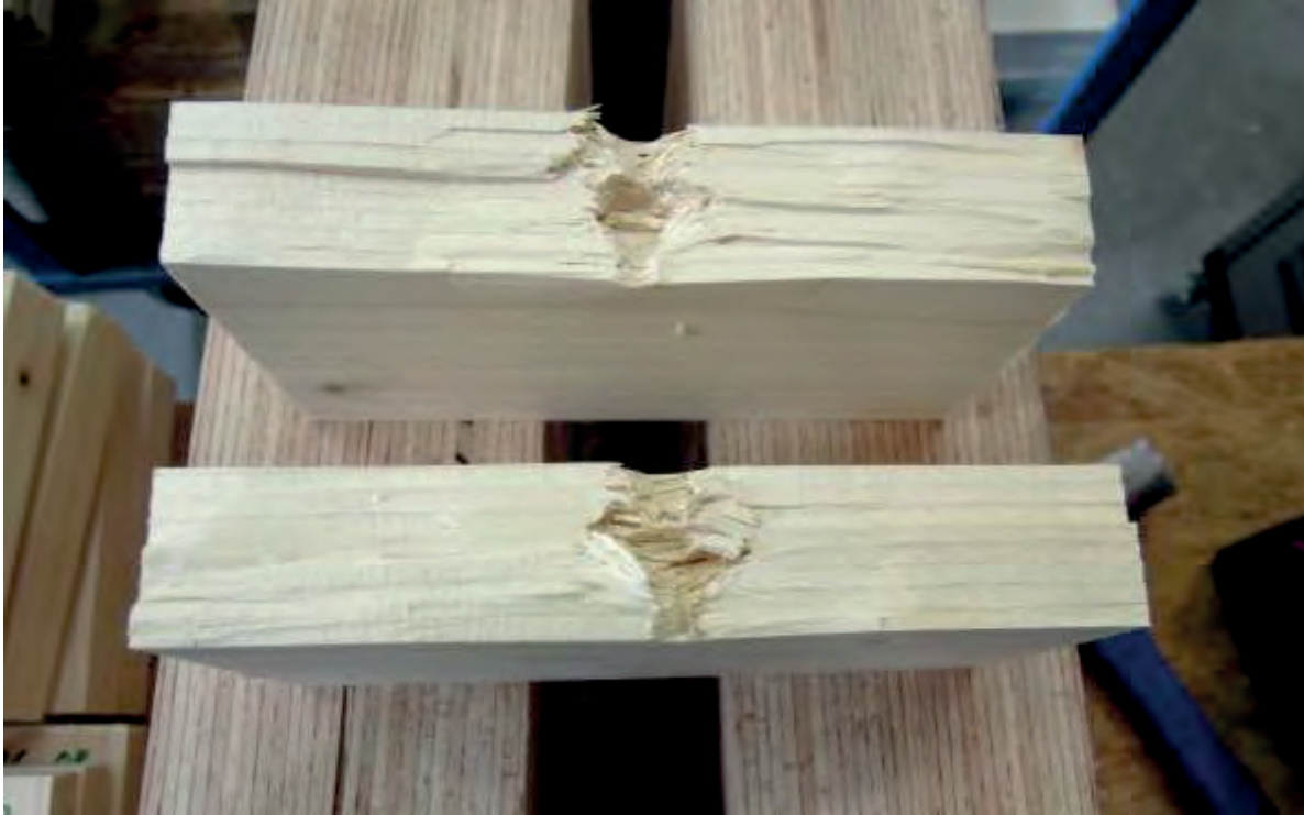
Abbildung 5-17: charakteristisches Bruchbild einer Kopfdurchziehprüfung mit Senkkopfschraube (K-12-27-B6-11)
