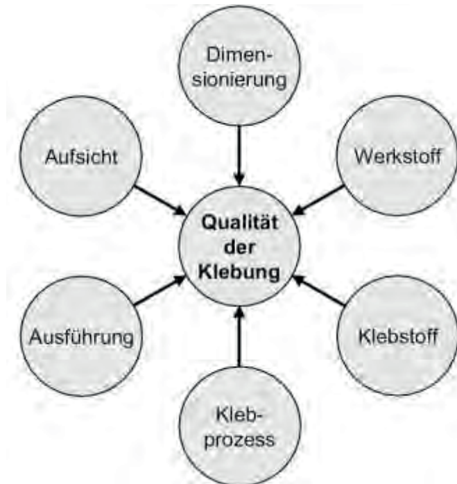
Abbildung 3-2: qualitätsbestimmende Faktoren einer Klebeverbindung [33]
