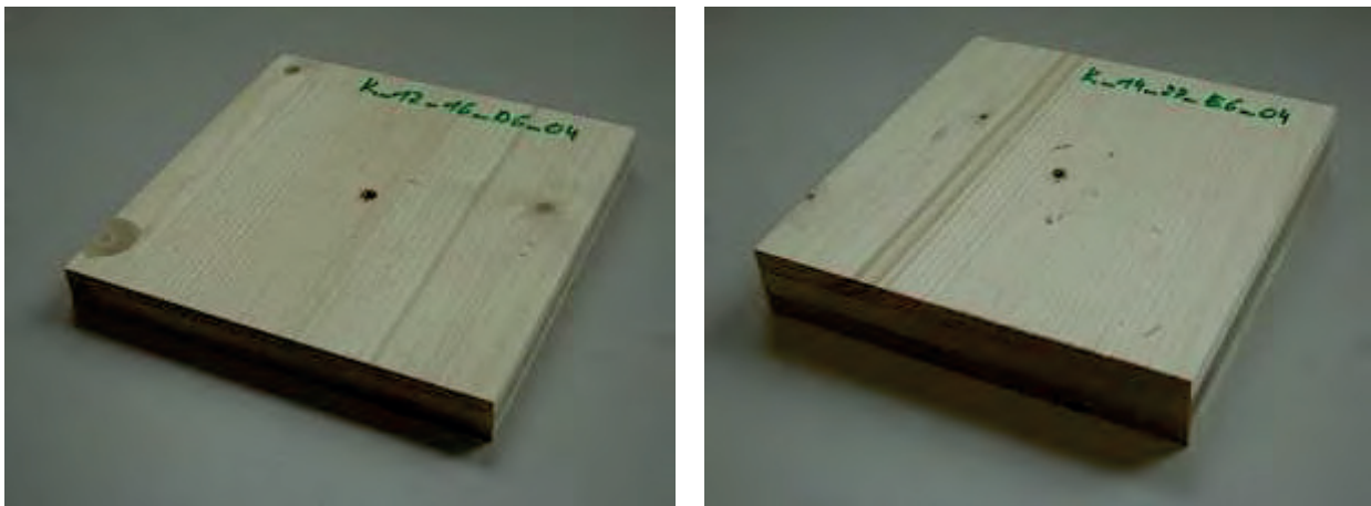
Abbildung 4-11: 16 mm 3S – Platte der Prüfserien D6 und D7 (li) und 27 mm 3S – Platte der Prüfserien J7, B8, E6, E7 und H8 (re)
