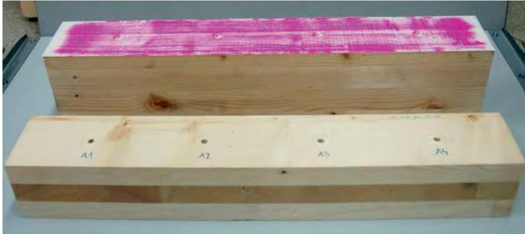
Abbildung 2-10: Druckmessfolien zwischen den nichtverklebten Fügeteilen [2]
