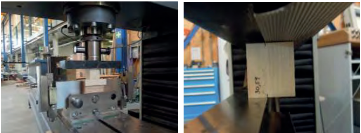
Abbildung 5-19: Darstellung der Scherprüfeinrichtung (li) und Detailaufnahme der Scherkante (re)
