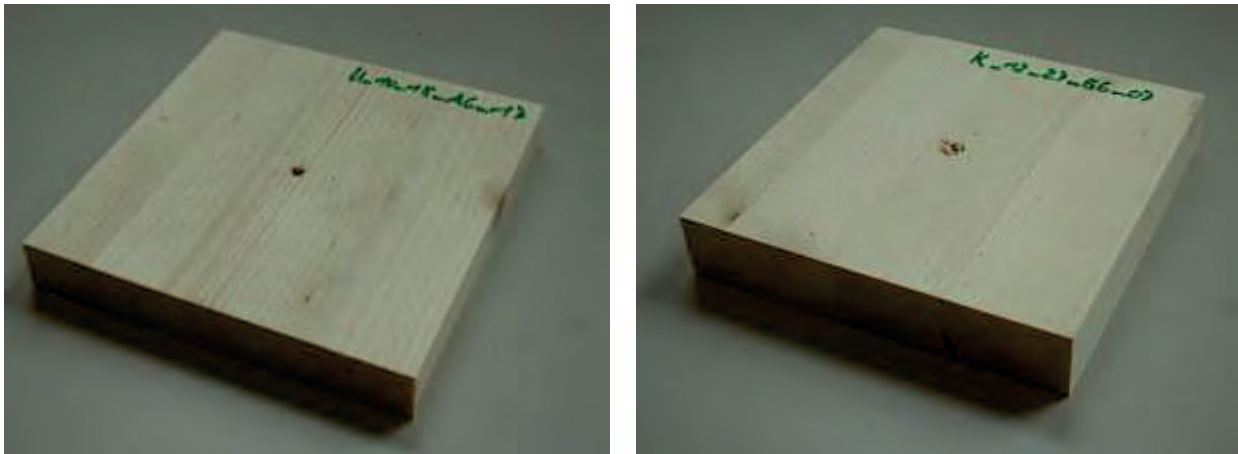
Abbildung 4-10: 18 mm 1S – Platte der Prüfserien A6, A7, O7 und F8 (li) und 27 mm 1S – Platte der Prüfserien B6, A8 und B7 (re)
