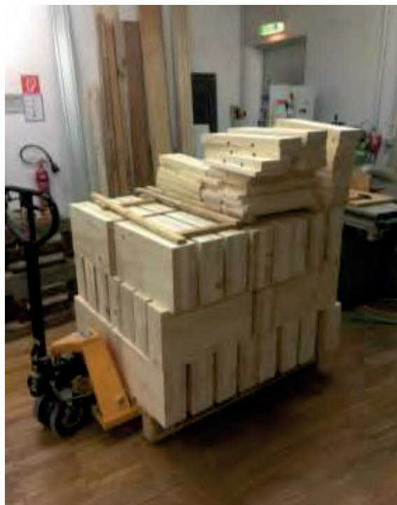
Abbildung 5-7: Zugeschnittene Prüfkörper (li) und BSP – Basiselement für die Vorversuche (re)
