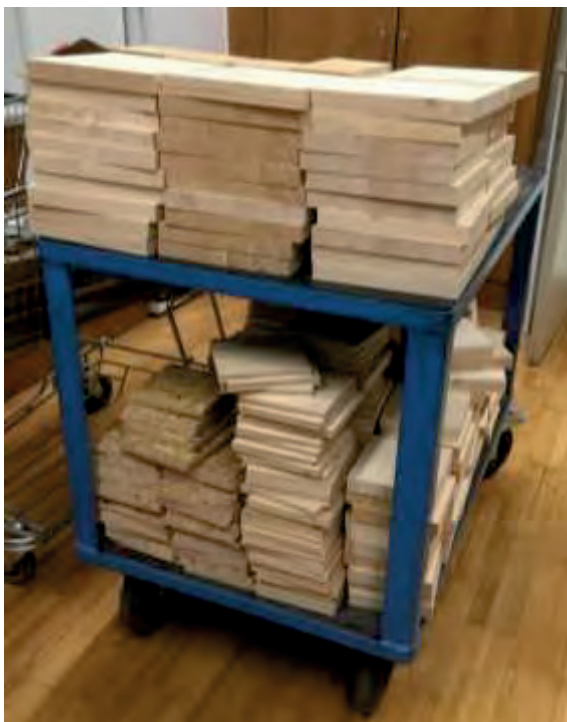
Abbildung 5-7: Zugeschnittene Prüfkörper (li) und BSP – Basiselement für die Vorversuche (re)
