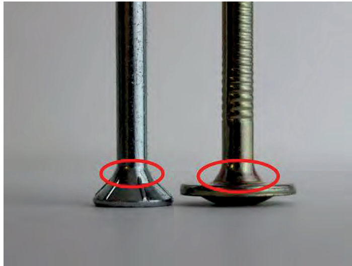
Abbildung 5-21: Detailaufnahme des Übergangs vom Schraubenschaft zum Senk- bzw. Tellerkopf
