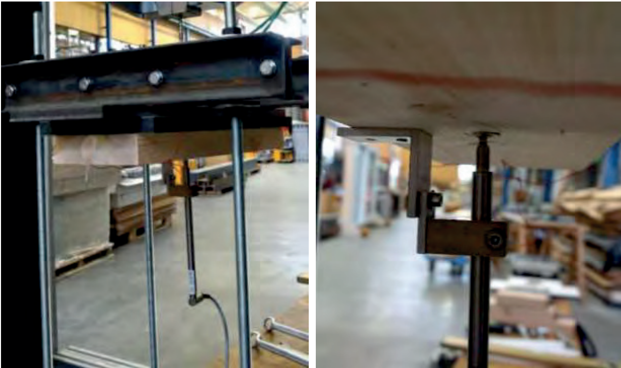
Abbildung 5-4: WA-T 10 – 100 mm Wegtaster von HBM (li) und Detailaufnahme der Kontaktpunktes von Wegtaster und Schraubenkopf
