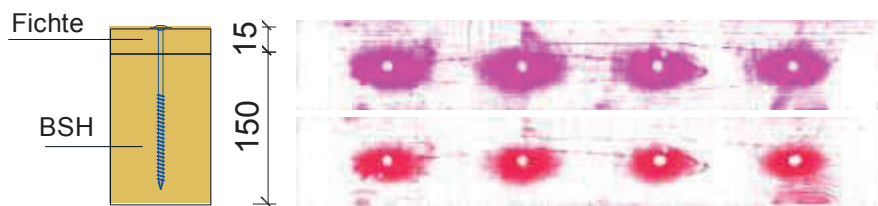
Abbildung 2-11: Fichte | t = 15 \text{ mm} | d_{\text{head}} = 22 \text{ mm} [24]
