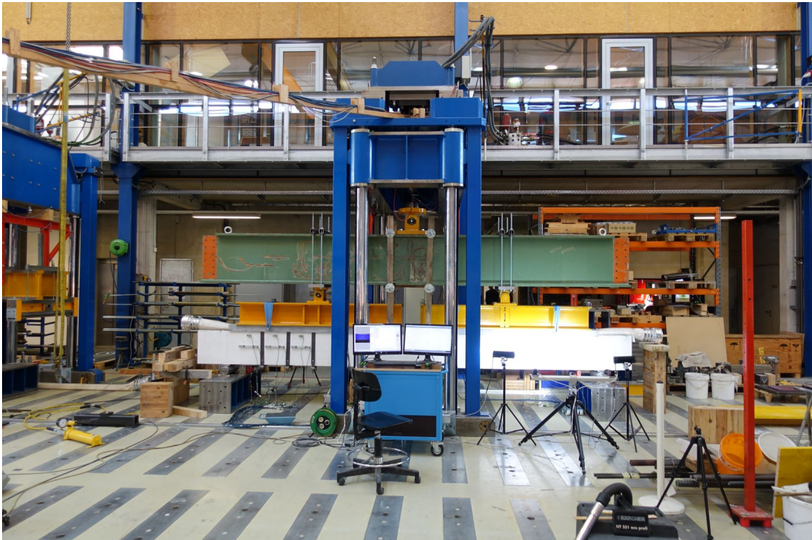
Abb. 4.8.: Prüfgerüst mit eingespanntem Balken (SV 22.01) und Messvorrichtungen
