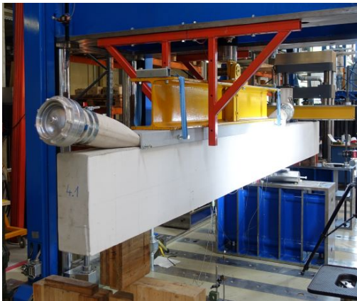
Abb. 4.12.: Versuchsaufbau der Kragträger am Beispiel von SV 30
