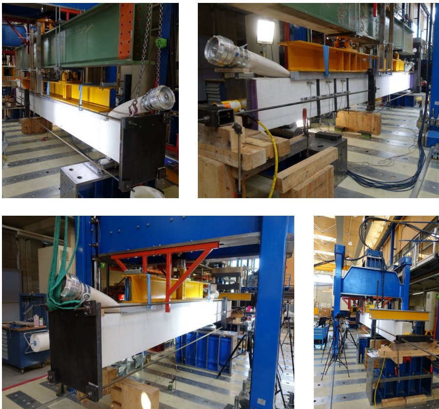
Abb. 4.16.: Normalkraft- und Prüfgerüst am Einfeldträger (oben) und am Kragträger (unten)
