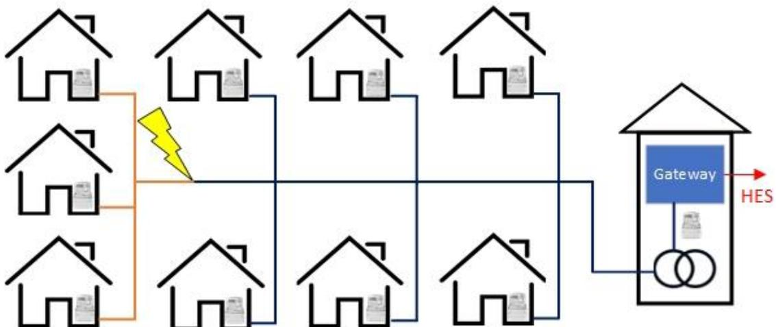
Abbildung 27: Verbindung erfolgt ausschließlich über PLC
