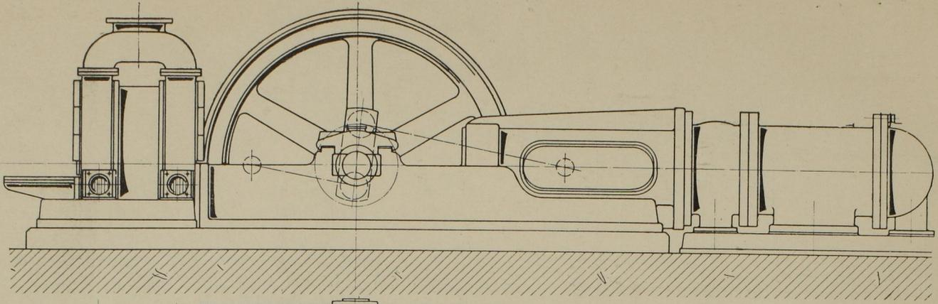
Abb. 87. Seitenansicht der Gebläsemaschine.
