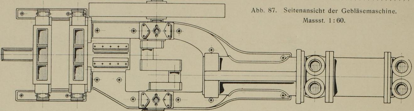
Abb. 88. Grundriss der Gebläsemaschine.
