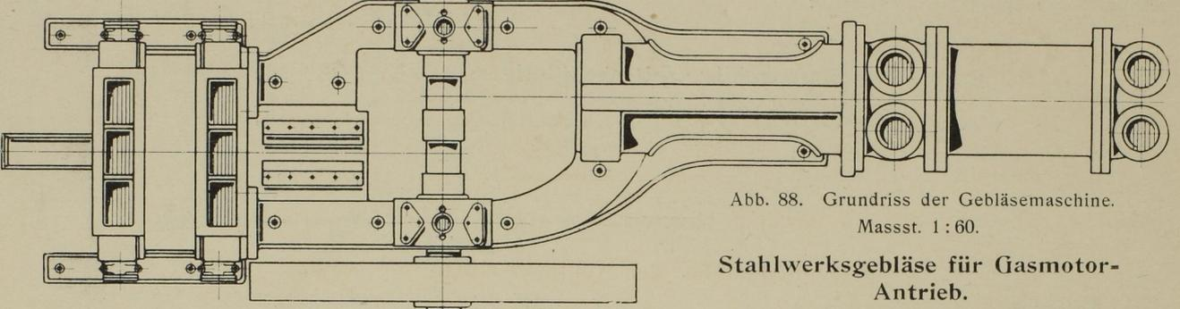
Abb. 89. Grundriss der Gebläsemaschine.
