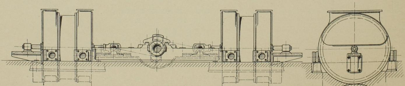
Abb. 90. Seitenansicht der Gebläsemaschine und Rückansicht des Windcylinders. Masst. 1:60.
