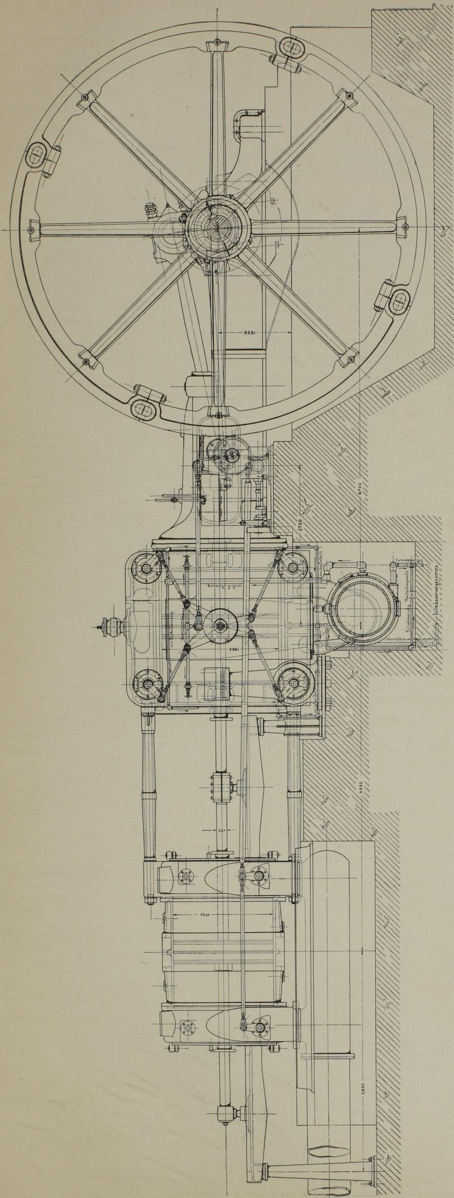
Abb 43. Seitenansicht der Niederdruckseite der Gebläsemaschine. Masst. 1 : 60.
