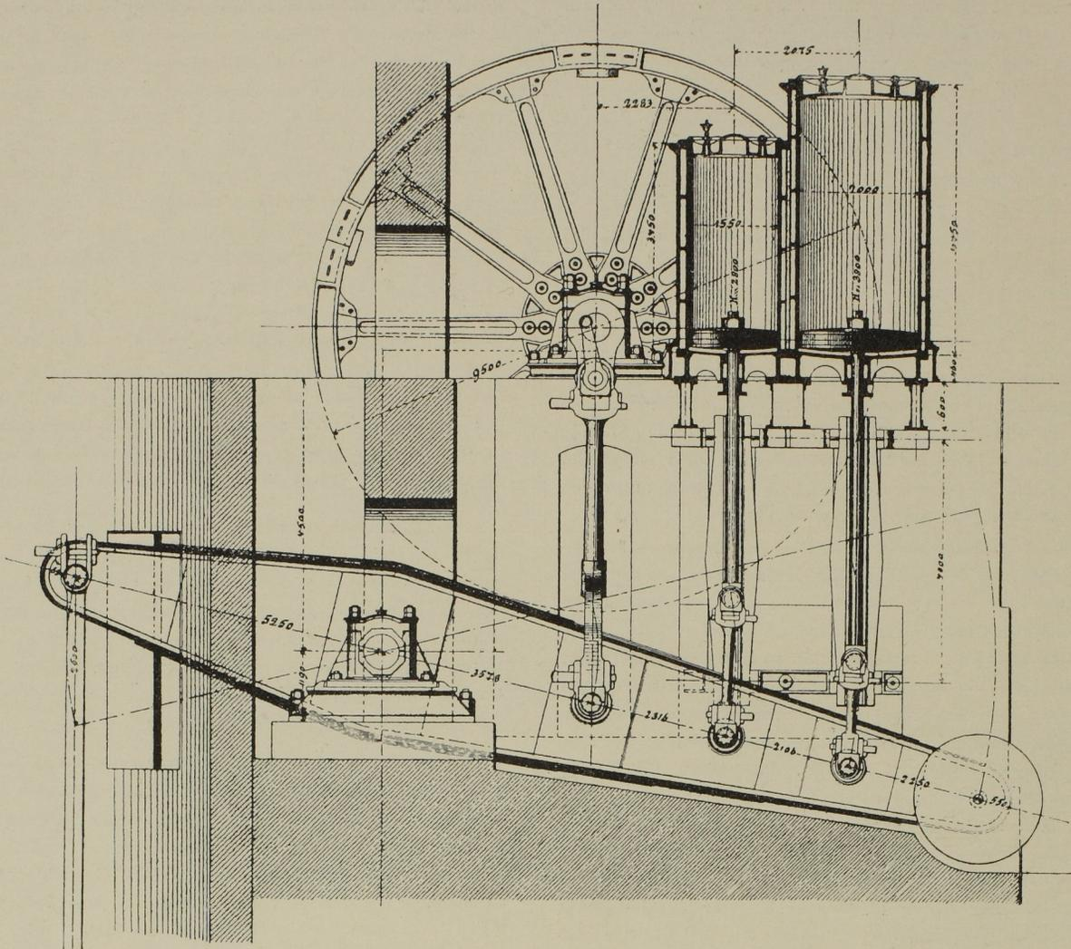
Abb. 44. Längsschnitt und Seitenansicht der Wasserhaltungsmaschine.
