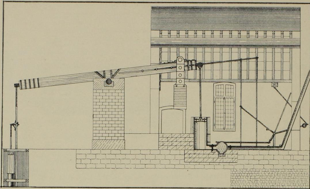
Abb. 42. Entwurf einer Wassersäulen-Maschine.
