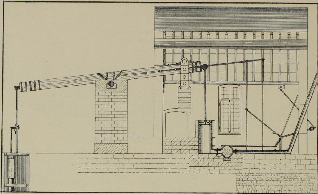
Abb. 42. Entwurf einer Wassersäulen-Maschine.
