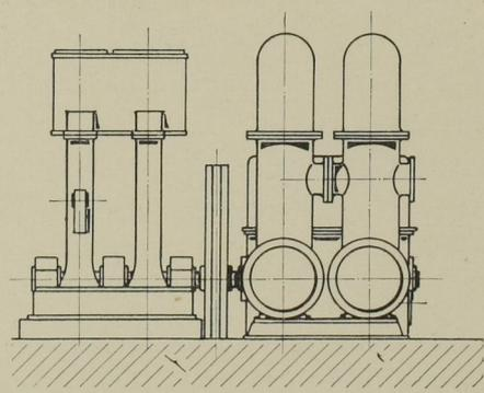
Abb. 17a. Stirnansicht der Pumpen samt Dampfmaschine.
