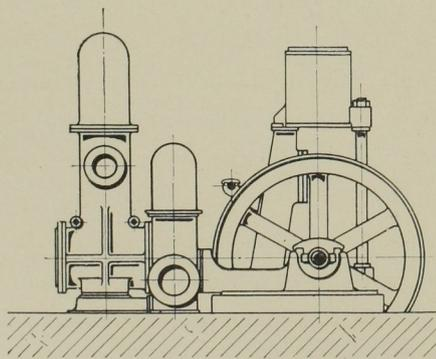
Abb. 16a. Seitenansicht der Pumpmaschine.
