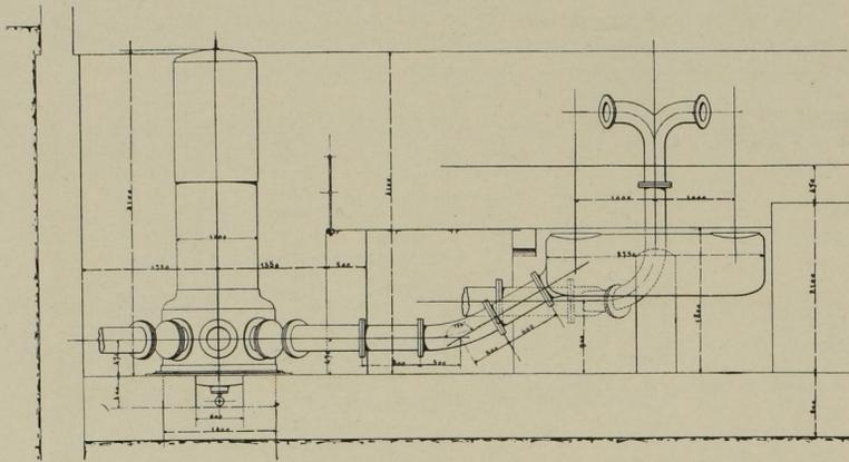
Abb. 34. Seitenansicht der Rohrleitungen und Windkessel. Masst. 1:75.
