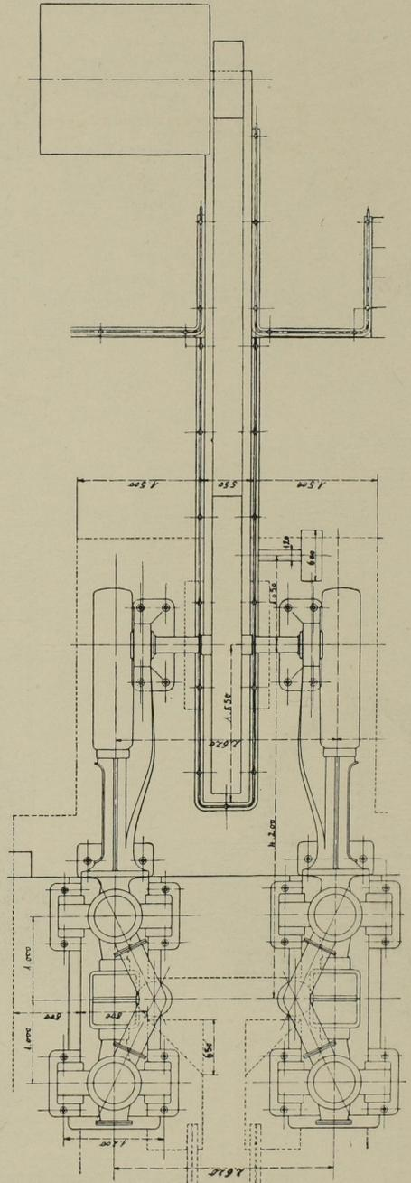
Abb. 35. Grundriss der Pumpmaschine. Masst. 1:75.
