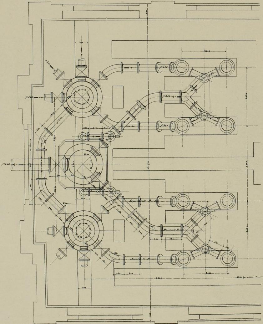
Abb. 33. Grundriss der Rohrleitungen und Windkessel. Masst. 1:75.
