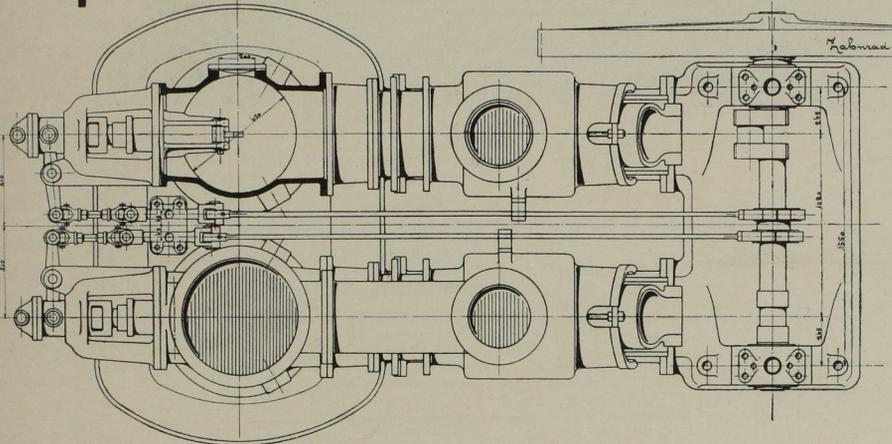
Abb. 20. Grundriss der Pumpe. Massst. 1 : 40.
