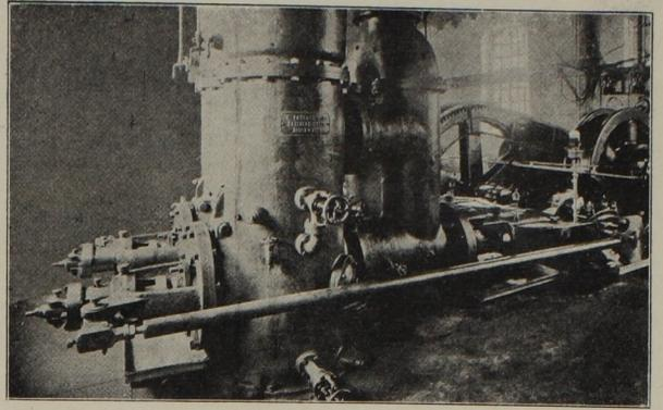
Abb. 22. Steuerungsantrieb.
