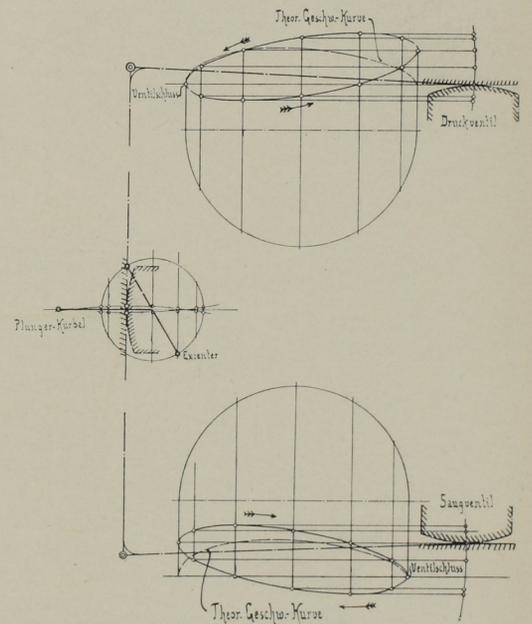
Abb. 24. Diagramm der Pumpen-Steuerung.
