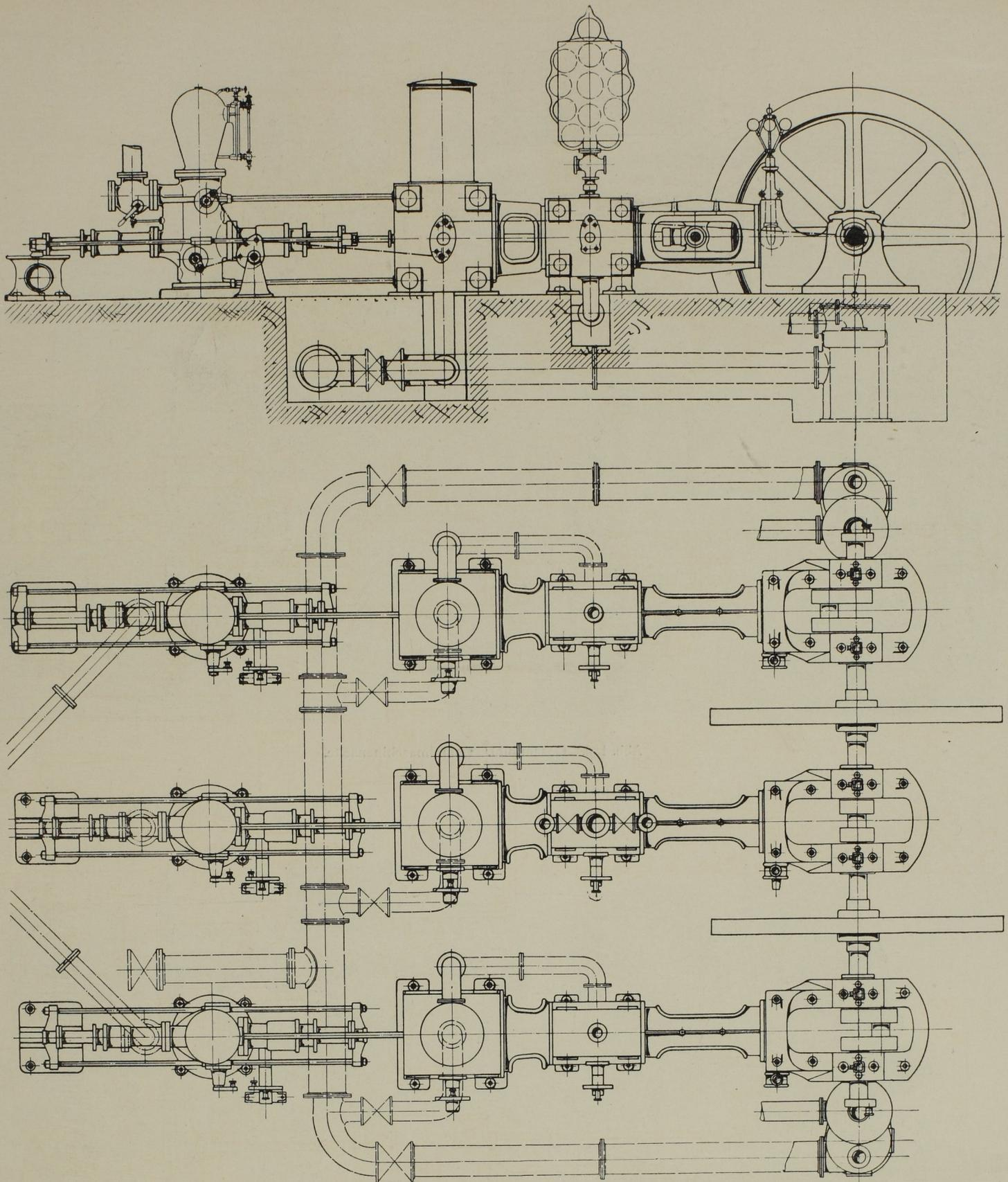
Abb. 149. Grundriss und Seitenansicht der Wasserhaltungsmaschine. Massst. 1:72.
