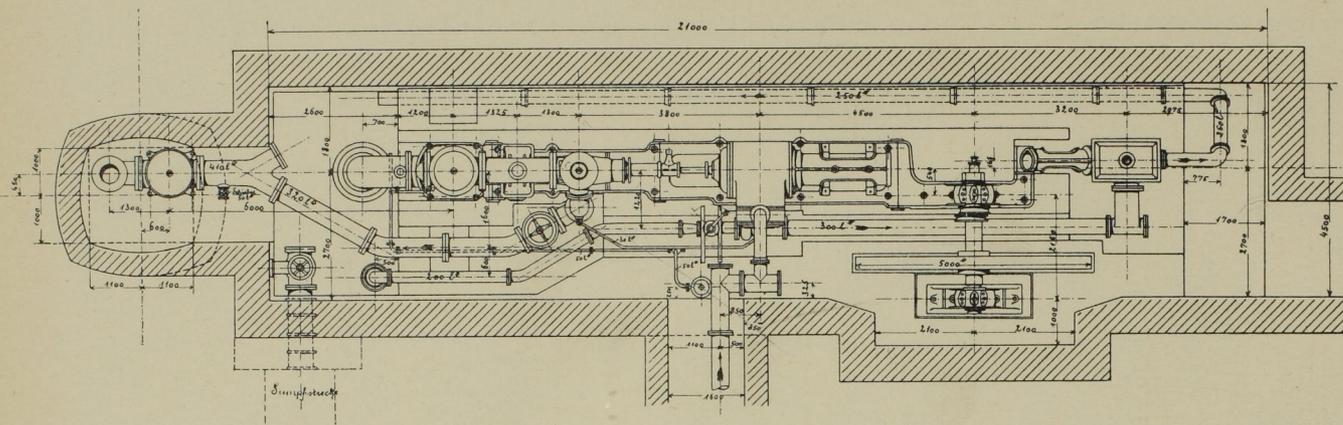
Wasserhaltungsmaschine der Max-Grube der Fürstl. Hohenloheschen Bergwerke, ausgeführt von der Wilhelmshütte in Eulau.
