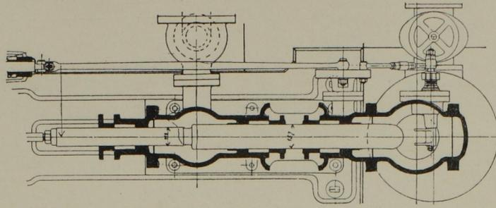
Abb. 82. Grundriss der Pumpe mit Steuerung. Masst. 1:30.
