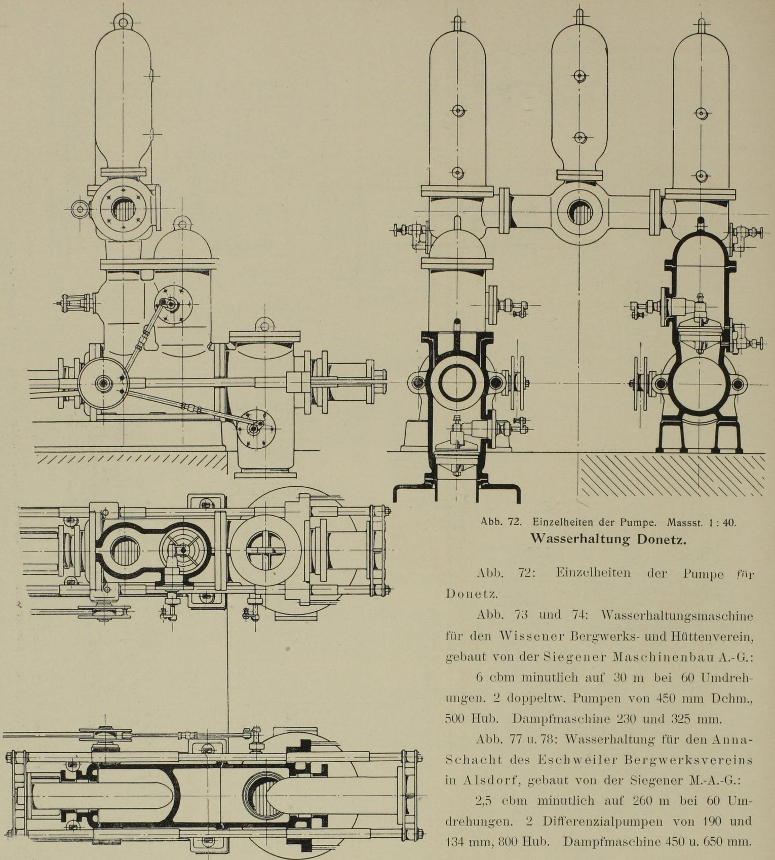
Abb. 72. Einzelheiten der Pumpe. Masst. 1:40.
