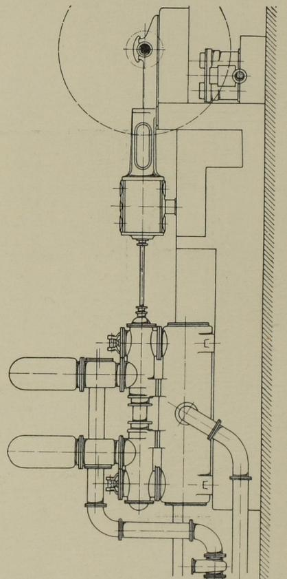
Abb 15. Seitenansicht und Grundriss der Pumpmaschine für Wyhlen. Masst. 1:50.
