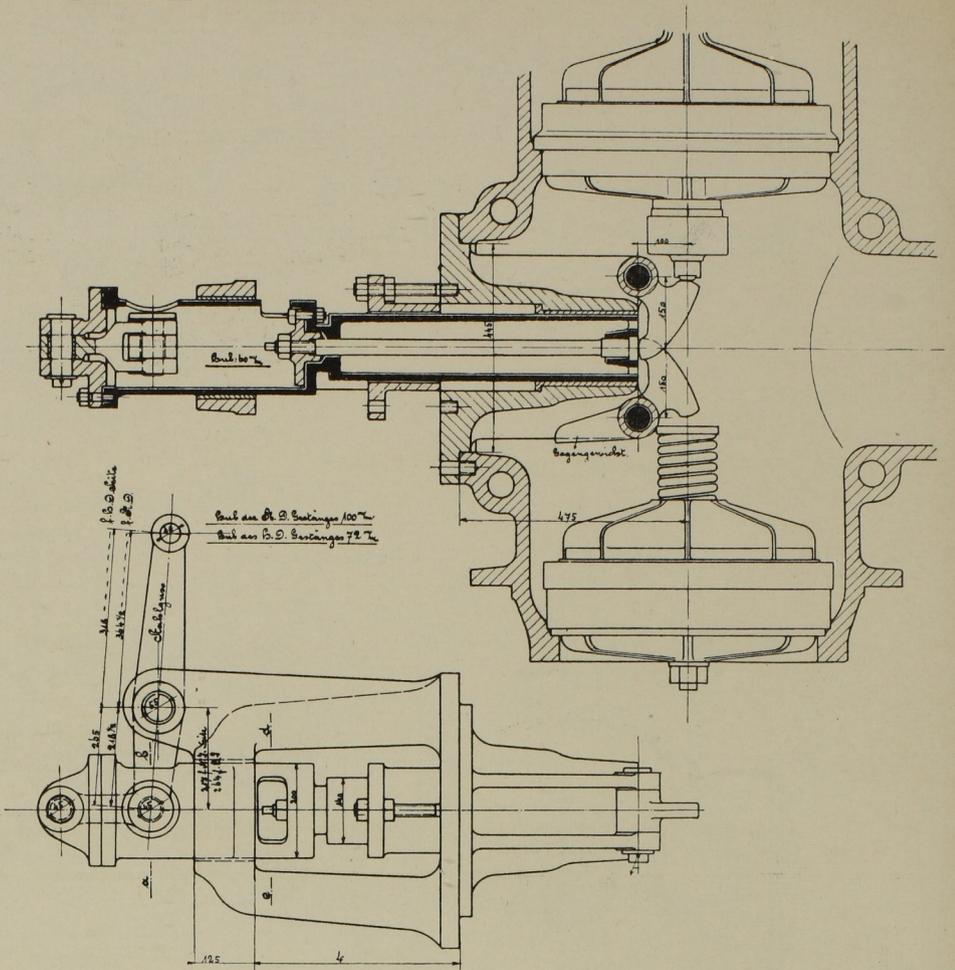
Abb. 13. Längsschnitt und Grundriss der Pumpe. Masst. 1:50.
