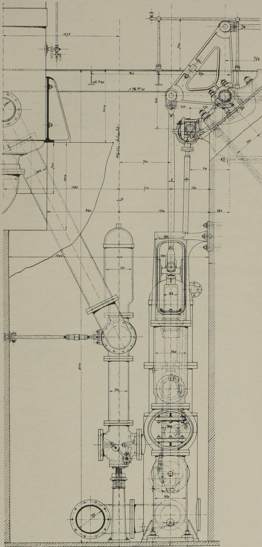
Abb. 245. Anordnung der Druckpumpen. Massst. 1:30.
