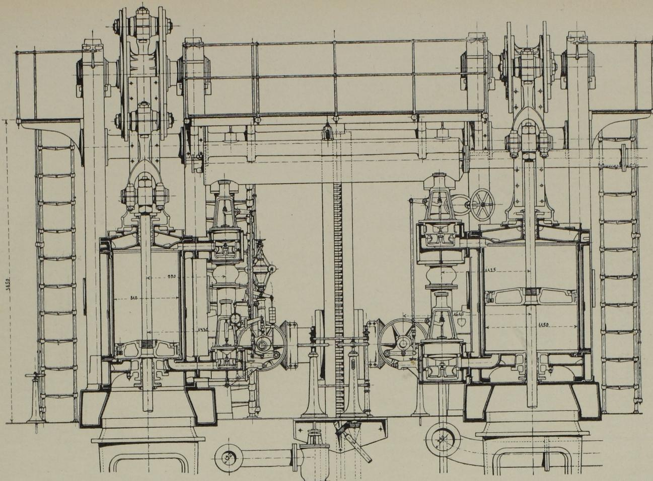
Abb. 220. Schnitt durch die Antriebs-Dampfmaschine. Massst 1:45.
