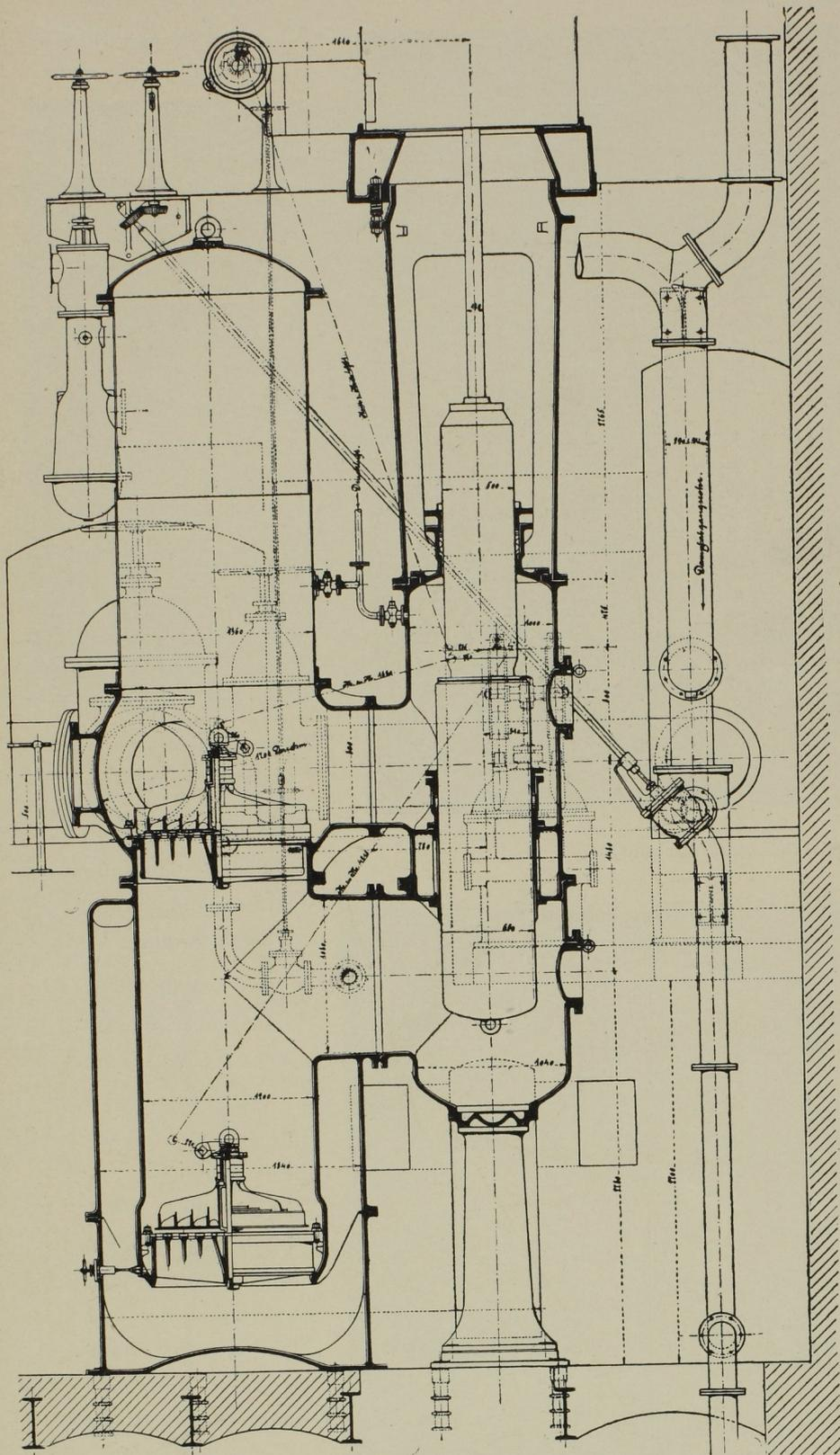
Abb. 215. Schnitt durch die Differenzial-Druckpumpe. Massst. 1 : 50.
