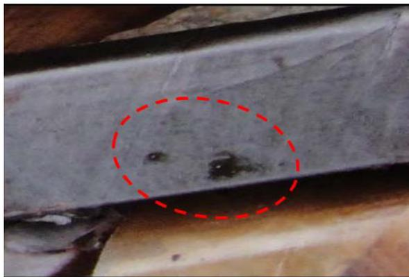
Bild 19: DGA-Auswertung (oben) und der elektrische Fehler an der Wicklung (unten) des 23,5/432-kV-Maschinentransformator [22]
