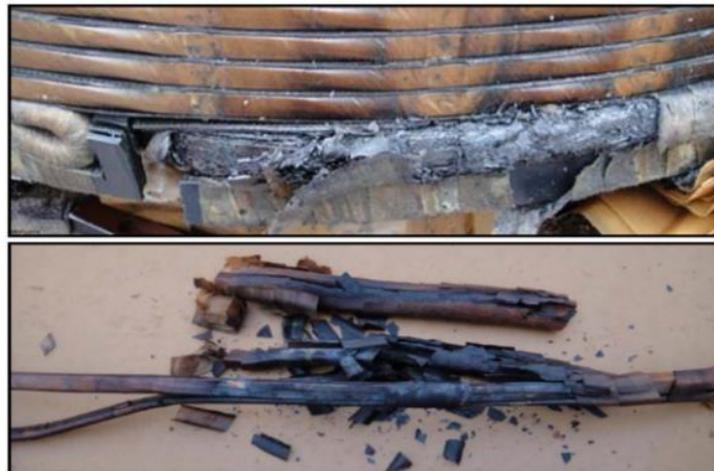
Bild 18: DGA-Auswertung (oben) und Windungsfehler (unten) der 275-kV-Drosselspule [22]
