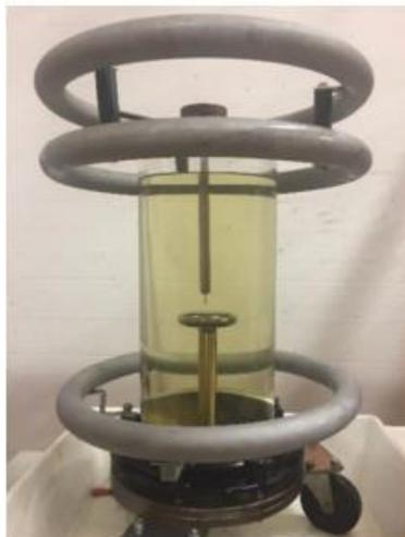
Bild 25: 16-Liter-Prüfgefäß für Durchschlagversuche mit AC- und Stoßspannung
