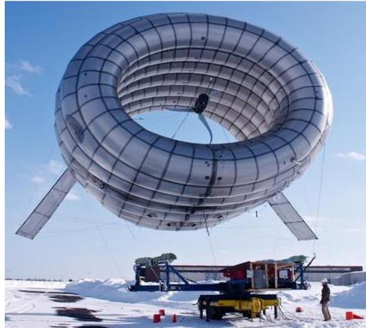
Abbildung 45: Buoyant Airborne Turbine [67]
