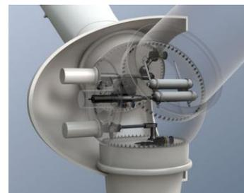
Abbildung 57: Mechanisches Pitch-System [129]
