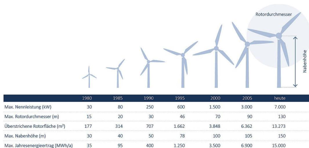
**Abbildung 1: Entwicklung der Windkraftanlagen im Laufe der Jahre [58]**
