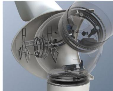
Abbildung 56: : Elektrisches Pitch-System [118]
