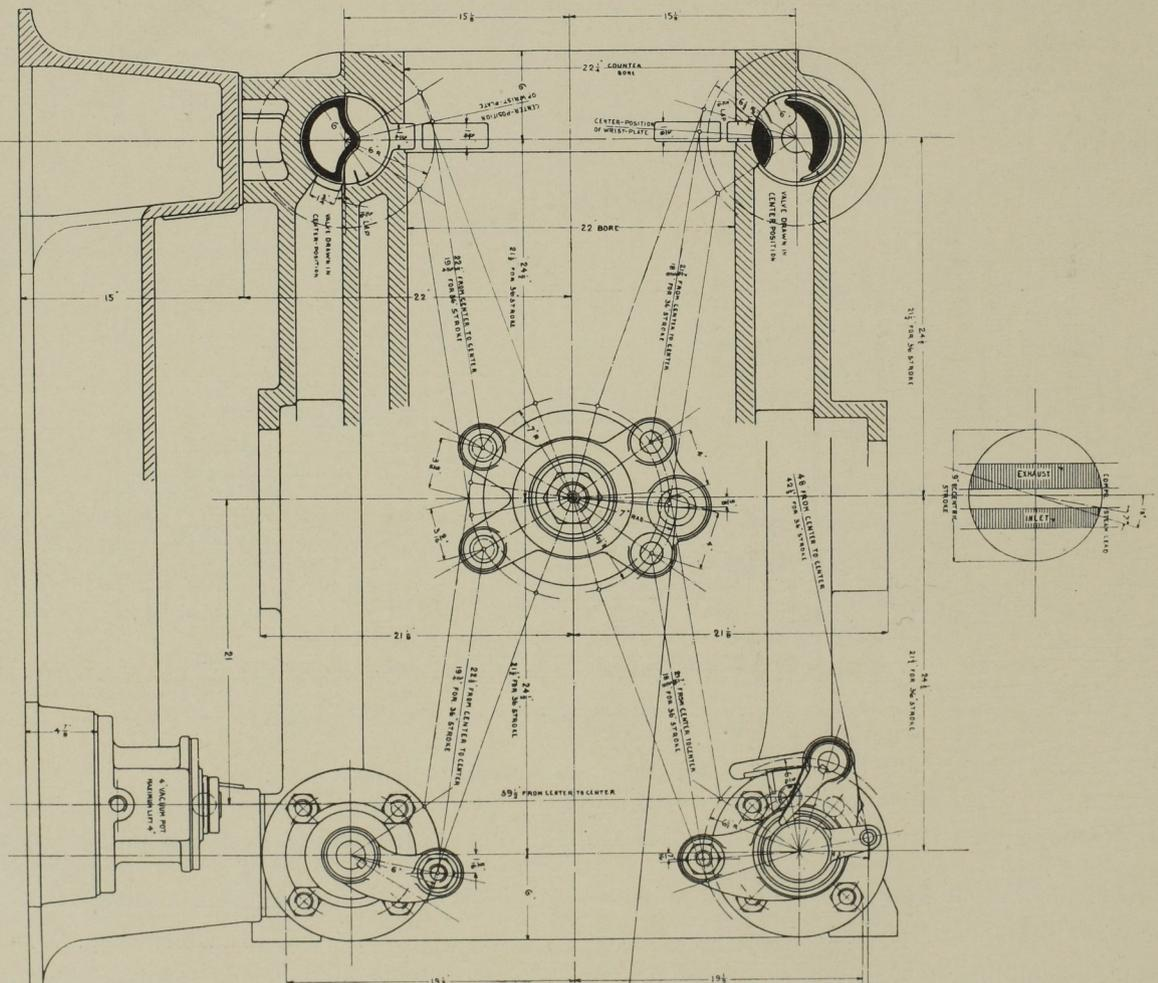
Abb. 188. Steuerung des Hochdruckzylinders. Massst. 1:12.
