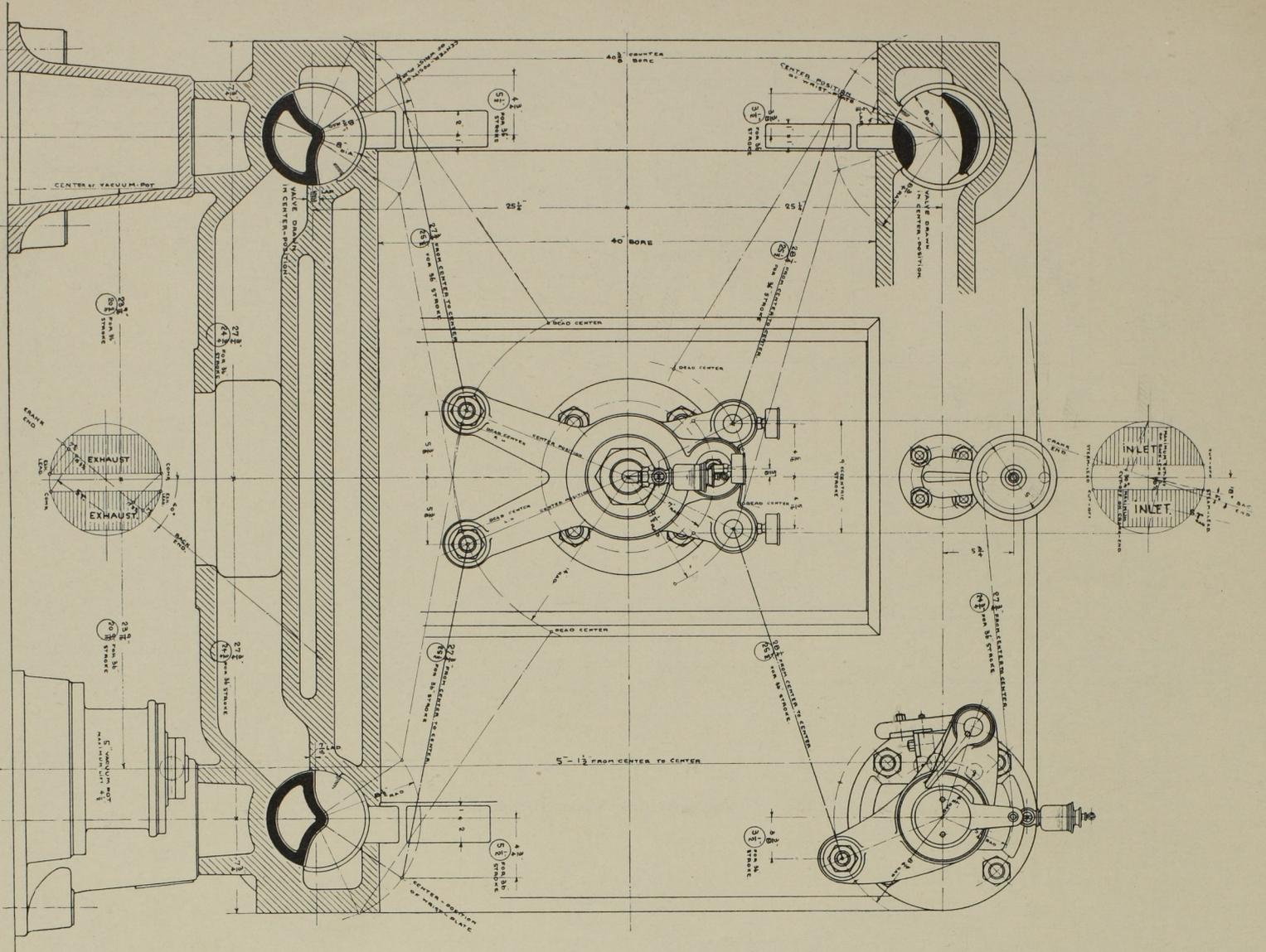
Abb. 187. Steuerung des Niederdruckzylinders. Massst. 1:12.
