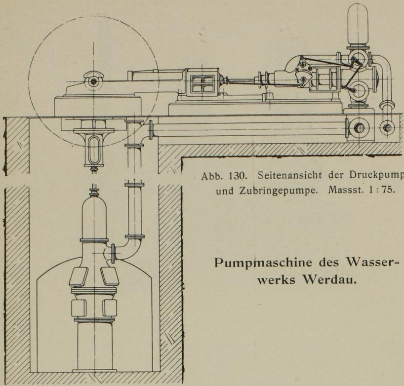
Abb. 130. Seitenansicht der Druckpumpe und Zubringepumpe. Masst. 1:75.
