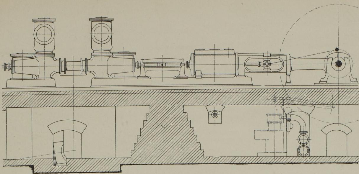
Abb. 42. Gesamtanordnung der Pumpmaschinen. Masst. 1:80.
