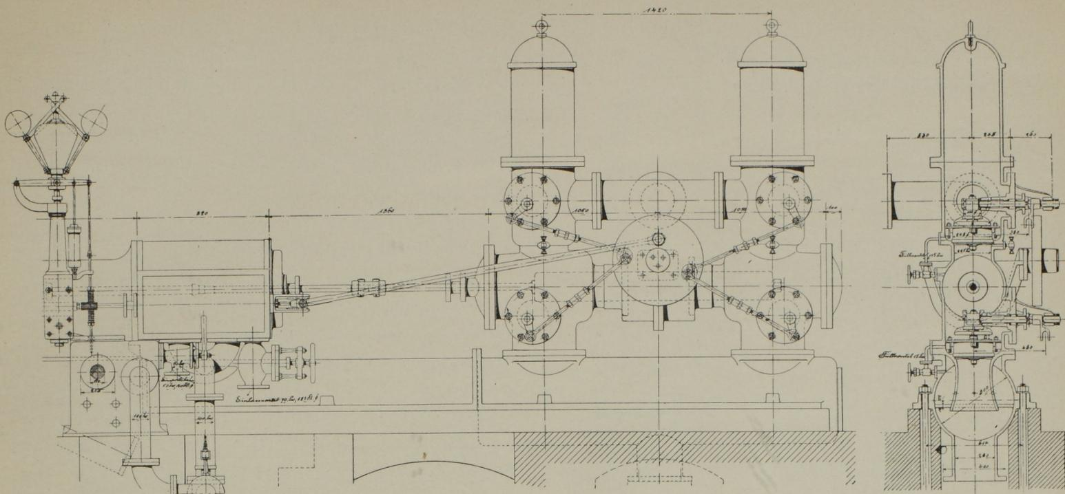
Abb. 17. Seitenansicht und Querschnitt der Druckpumpen mit Steuerung. Masst. 1:30.
