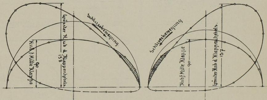
Abb. 49. Klappen-Diagramme (Saugsteuerung, hintere Seite). Masst. 1:4.
