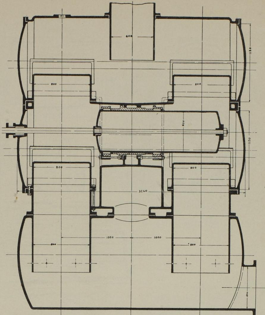
Abb. 46. Längsschnitt der Druckpumpen. Masst. 1:30.
