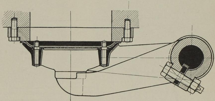
Abb. 48. Pumpenklappen mit Steuerhebel. Masst. 1:5.
