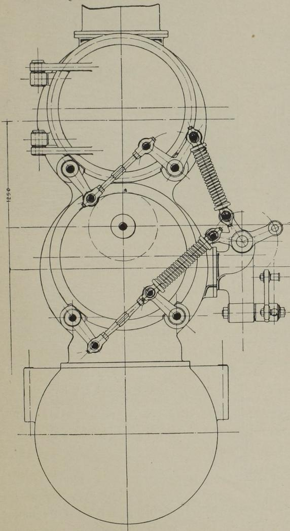
Abb. 47. Seitenansicht u. Steuerung. Masst. 1:30.
