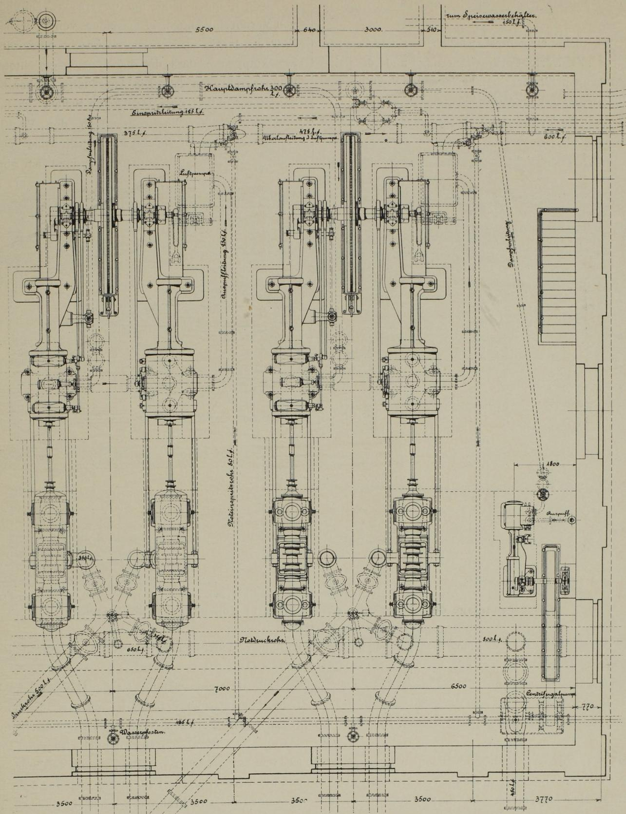
Abb. 43. Grundriss der Maschinenanlage und der Rohrleitungen. Massst. 1:100.
