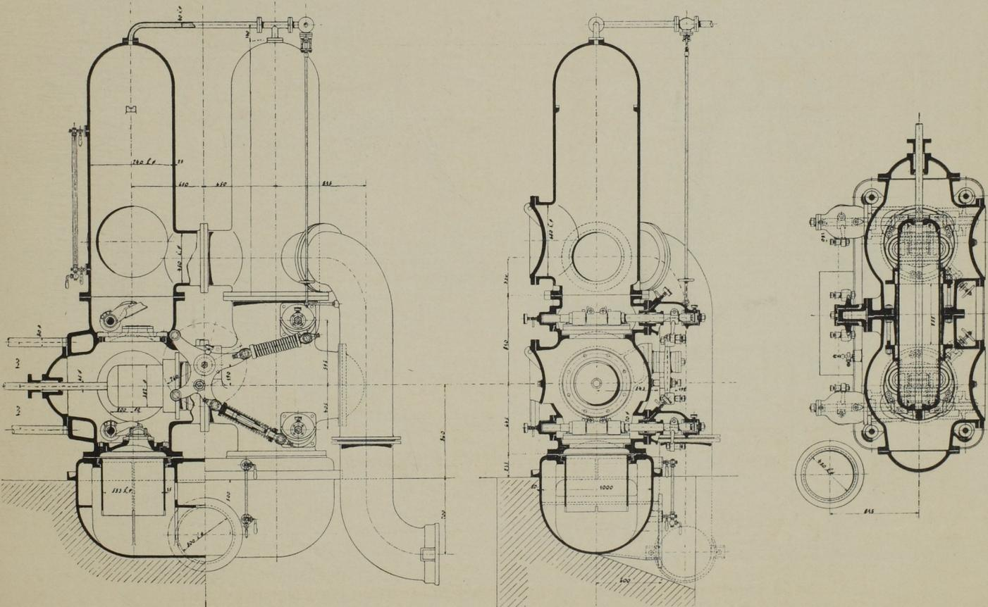
Abb. 36. Seitenansicht und Schnitte der Druckpumpe. Massst. 1:40.
