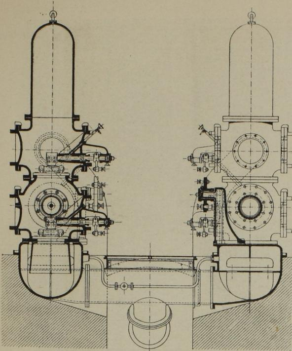
Abb. 33. Druckpumpe. Massst. 1:50.
