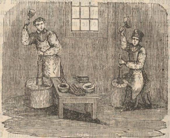
einem Rand versehenen Tisch, die zu diesem Geschäft nöthigen Geräthschaften alle zusammen, deren sind: die Hüllen, die vier hohlen und die beiden massiven Sezer, die Ladefchaufel zum Messen der Ladungen, eine Mulde oder viereckigen Kasten, welcher mit Schiebdeckel versehen ist, und den Saß enthält, so wie der Schlägel, Bindfaden, Pfriemen, Scheere und dergleichen. Man schraubt den Dorn auf den Untersaß
