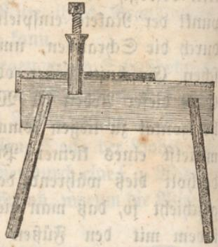
Da die Seele einer Rakete aber keineswegs cylindrisch seyn darf, sondern wenn diese steigen soll, eine conische Gestalt haben muß, so bedient man sich hierzu eines dreikantigen conischen Bohrers, in der Kunstsprache (der Feuerwerker) Aufräumer genannt. Seine Gestalt ist die einer abgestumpften dreiseitigen Pyramide.
