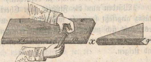
einen Triangels rechts, der vorspringende Theil des anderen dagegen links niedergebogen wird, dieses giebt die Kante x — g, welche auf die Hülse aufgelegt wird. Nach dieser Operation ist der Flügel fertig. Man nimmt ihn zwischen den Brettchen hervor und legt ihn hin zum Trocknen. Ganz auf dieselbe Weise verfährt man nun auch mit allen übrigen Flügeln.
