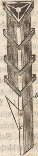
Man schraubt ohngefähr  $\frac{3}{4}$  von der Höhe des Conductors, aufwärts gemessen, auf der Rückseite des langen Brettes einen Hakenkloben ein, welcher in das Loch eines Ringnagels paßt, der in einer bequemen Höhe an einen Pfosten zc. befestigt werden kann, damit man nicht genöthigt ist, sich zu bücken, wenn man die Raketen anzünden will.
