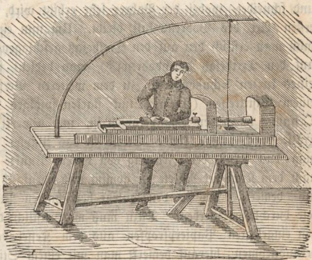
Der erwähnte Trog selbst kann, durch unter der Bohrmaschine angebrachte eiserne Schrauben nach Maßgabe der Kaliber der Raketen hoch und tief gestellt werden, und wird bei dem Gebrauch mit einer Wasserwaage völlig horizontal gestellt. Das Hoch- und Tiefschrauben des
