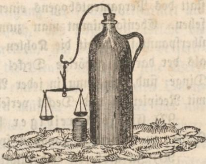
Von einer abgenutzten Schreibfeder schneidet man sich eine Art Ladeschaufel, um damit ganz kleine Quantitäten in die Wage eintragen zu können. Ist die Probe genau abgewogen, so läßt sich das Verhältniß für größere Quantitäten leicht berechnen. Da man sich aber bei kleinen Quantitäten sehr leicht täuscht, oft das Doppelte nimmt, ohne es zu bemerken, so muß die Wage äußerst subtil seyn, wenn man hiernach das Verhältniß im Großen be-
