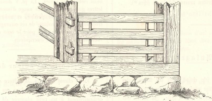
Wenn statt der Eckständer die wagrechten Hölzer in den Ecken übereinander gelegt sind, so wird längs dem Heuboden ein kleiner Raum von einigen Zollen zwischen denselben gelassen, an den Wänden der Stallung aber werden die Hölzer dicht auf einander gelegt, wie folgendes Beispiel einer Scheuer bei Meyringen zeigt.
