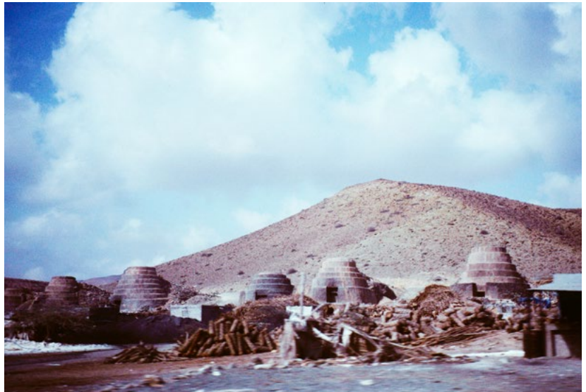
Abb. 171 Kalköfen an der Südküste, westlich von Al Mukalla. Hier wird mit Palmenholz der aus Steinbrüchen in der Nähe kommende Kalkstein gebrannt.
