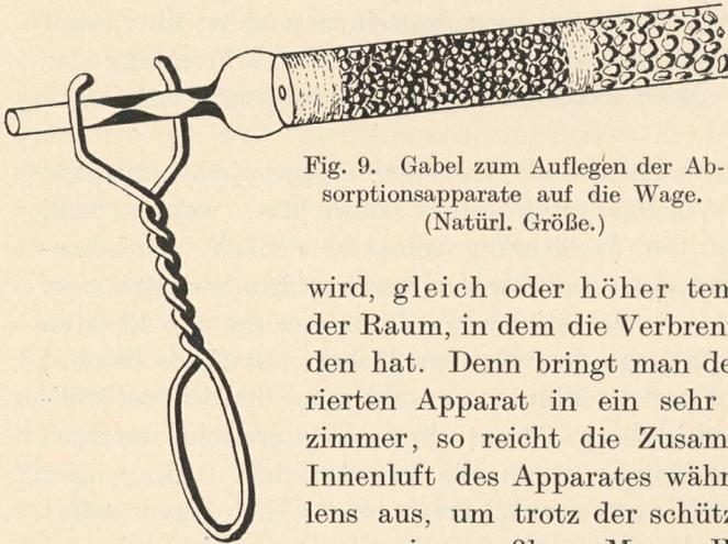
Fig. 9. Gabel zum Auflegen der Absorptionsapparate auf die Wage.
