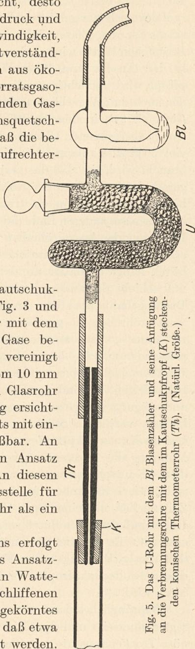
Fig. 5. Das U-Rohr mit dem *Bl* Blasenähler und seine Anfügung an die Verbrennungsröhre mit dem im Kautschukpfropf (*K*) steckenenden konischen Thermometerrohr (*Th*). (Natürl. Größe.)
