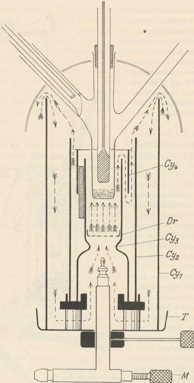
Abb. 37. Apparat zur Bestimmung des Molekulargewichtes aus der Siedepunkts-
