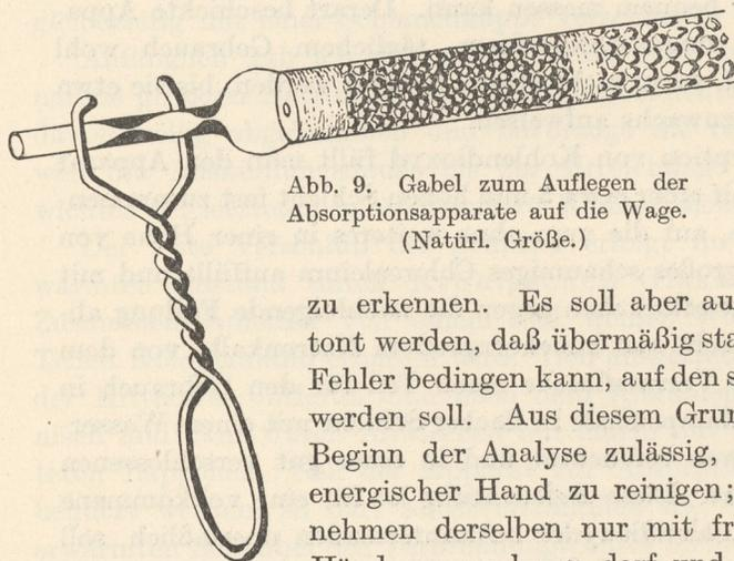
Abb. 9. Gabel zum Auflegen der Absorptionsapparate auf die Wage. (Natürl. Größe.)
