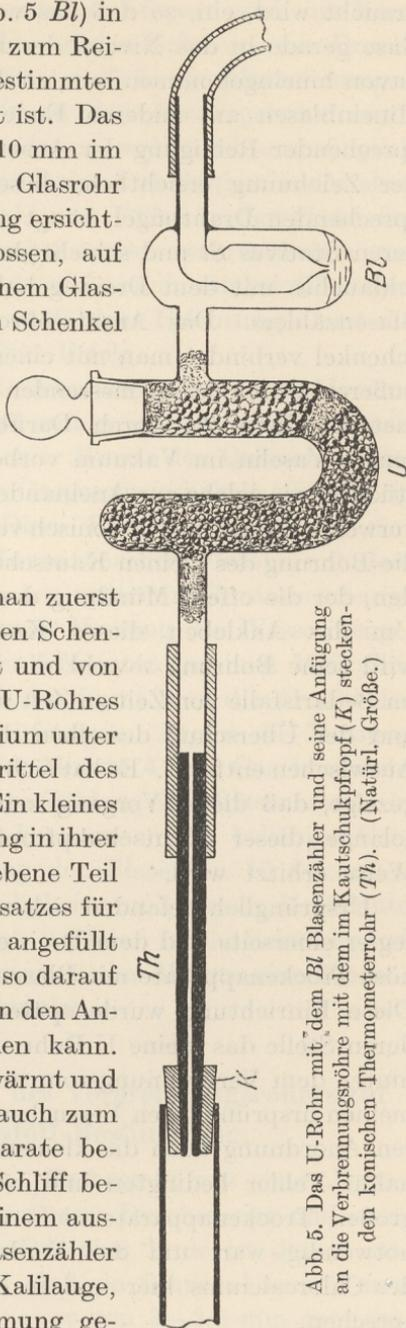
Abb. 5. Das U-Rohr mit dem *Bl* Blasenzähler und seine Anfügung an die Verbrennungsröhre mit dem im Kautschukpfropf (*K*) steckenden konischen Thermometerrohr (*Th*). (Natürl. Größe.)
