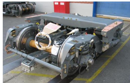
Abbildung 5: Vergleich Außen- und Innenlagerung eines Fahrwerks (SIEMENS Mobility Werk Graz, 2016) (Bombardier Inc., 2007)
