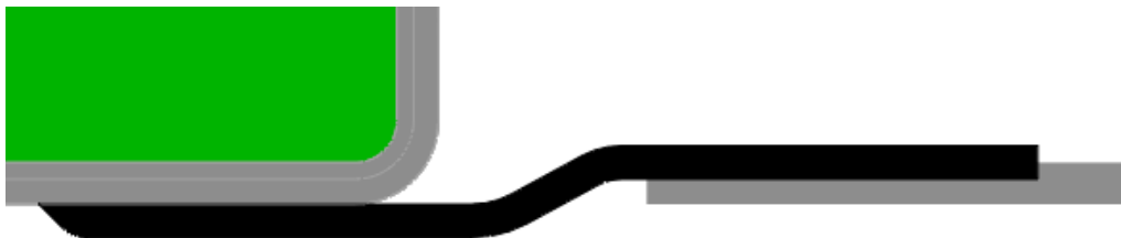
Abbildung 47: Profildichtung mit elastischem Kern
