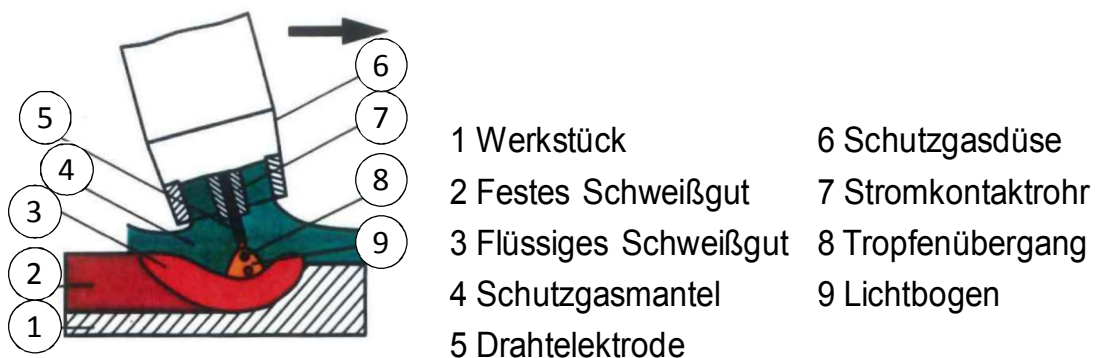
Abbildung 21 Metall-Schutzgasschweißen
