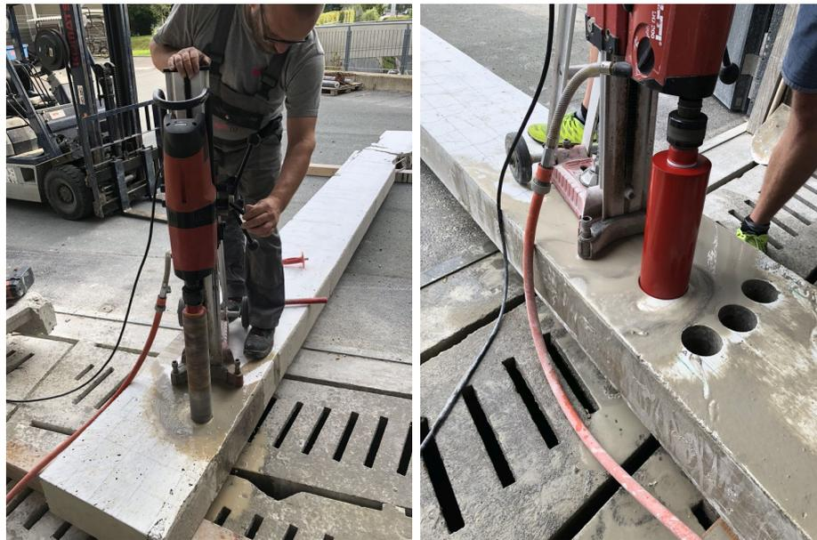
(a) Kernbohrung  $\varnothing 7$  cm(b) Kernbohrung  $\varnothing 10$  cm**Abb. 4.12.:** Bohrkernentnahme
