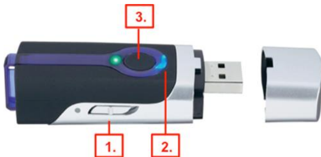
Abb. 12: Funktionsweise des verwendeten Datenloggers (Quelle: Conrad (2018); ergänzt).
