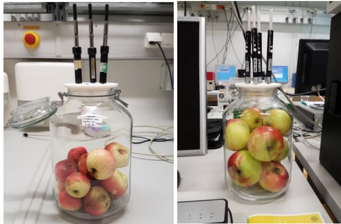
Abbildung 28: Der Exponiervorgang (1 h bei Raumtemperatur) für die unversehrten Äpfel
