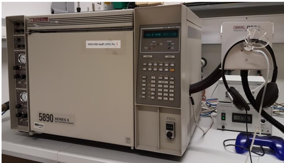
Abbildung 19: Abbildung eines Gaschromatographen mit dem Anschluss für die Olfaktometrie, dem Glaskonus
