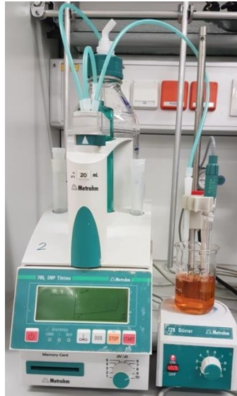
Abbildung 33: Autotitrator 785 DMP Titrino von Metrohm, zur Bestimmung des Säuregehaltes des Apfelsaftes verwendet
