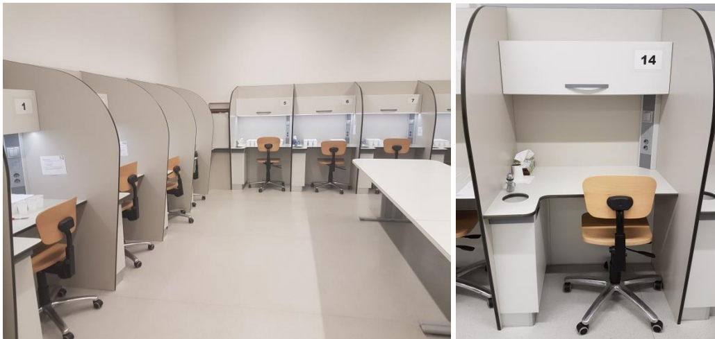
Abbildung 21: Prüflabor unter der Norm DIN EN ISO 8589:2010 und auf dem zweiten Bild eine Kostkoje
