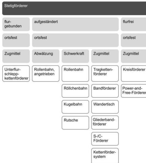
Bild 2-5: Systematik der Stetigförderer für Stückgutförderung [HSN+07, S. 124]
