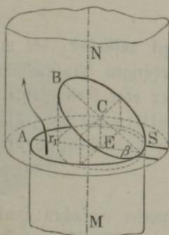
Ventilmündung eine dem Querschnitte der Ventilkammer und dem Ventilhube wieder eine dem Ventildurchmesser entsprechende Größe zu geben. Ist  $r$  der Halbmesser  $CD$  der Ventilkammer oder Kolbenröhre  $N$ , Fig. 588, sowie  $r_1$  der mittlere Halbmesser  $CB$  eines Subventiles  $BB$  gleich dem mittleren Halbmesser der Durchgangsöffnung  $AA$ , und  $s$  der Hub  $AB$  des Ventiles, so
