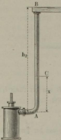
Verzögerung  $p_w' = g \frac{b}{l_2}$  kleiner ausfällt, als  $\frac{F}{f} \frac{u^2}{r}$ , was bei einer genügenden Länge  $l_2$ ' des horizontalen Rohrstückes *CB* sehr wohl stattfinden kann, selbst wenn für den Punkt *A* an der Pumpe der Bedingung genügt ist,
