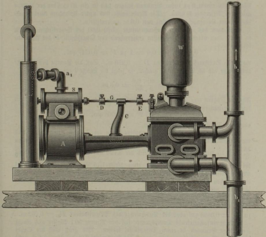
dadurch mit einer einfachen Condensation versehen, daß man den abgehenden Dampf aus dem Rohre  $a_2$  direct nach dem Saugrohre  $b_1$  der Pumpe leitet, so daß das condensirte Wasser gleichzeitig mit dem geförderten Wasser durch das Druckrohr  $b_2$  ausgetragen wird. Neben dem durch die Condensation erzielten Kraftgewinne wird hierdurch der Wegfall der umständlichen Rohrleitung für die Abführung der gebrauchten Dämpfe ermöglicht.
