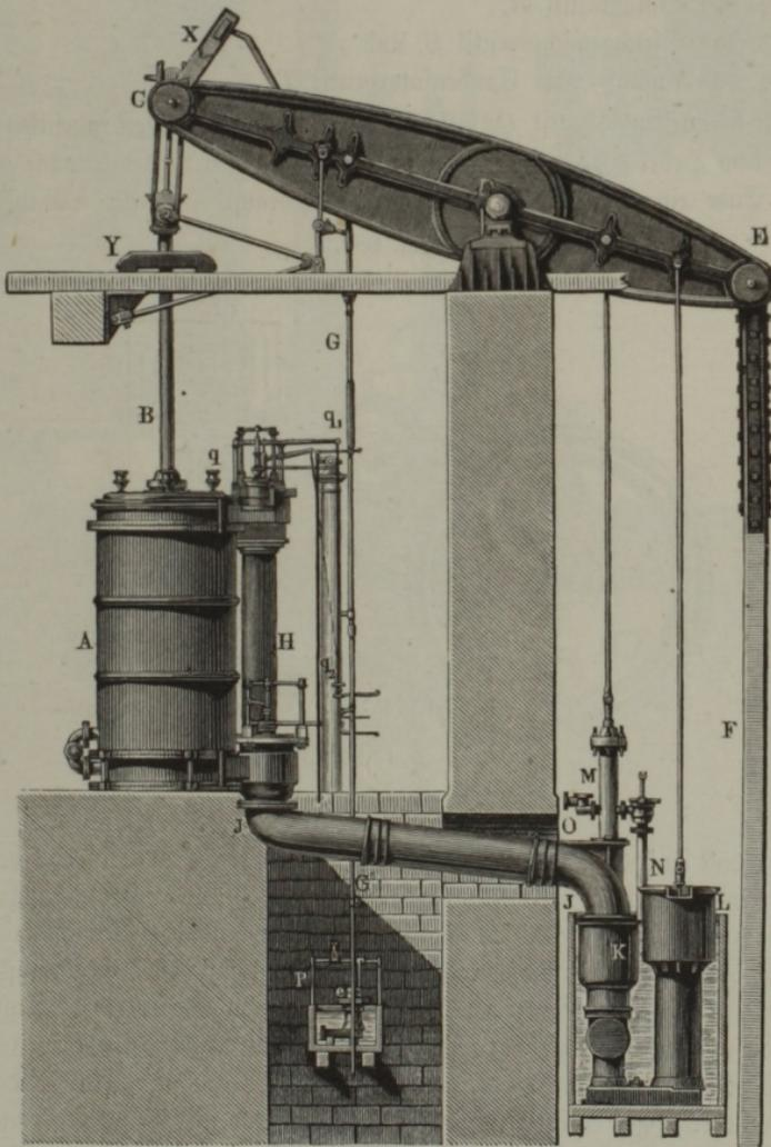
ist auch noch aufgehangen: die Steuerstange *G*, die Kolbenstange der Speisepumpe *M* und die Kolbenstange der Luft- und Warmwasserpumpe *L*.
