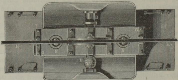
Hälfte die Längsansicht der Spritze, während Fig. 634 den Grundriß und Fig. 635 den verticalen Querschnitt durch den Windkessel darstellt. Man sieht in *B, B* die Cylinder, in *A* das Saugrohr, in *C, C* die Gurgelröhren, in *R* den Windkessel mit dem Ausgußrohr *D*. Das Saugrohr hat
