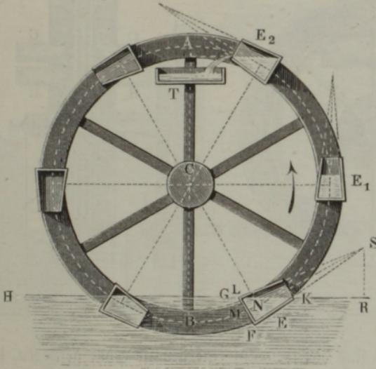
das Wasser *HR* tauchen, zum großen Theil mit Wasser an, welches sie in das Gerinne *T* nahe unter dem Rad Scheitel *A* wieder ausgießen. Damit durch dieses Rad so viel wie möglich Wasser gehoben werde, stellt man dasselbe so tief in das letztere, daß die Neigung der Axe des aus dem Wasser *HR* (Fig. 557) heraustretenden Eimers *E* gegen den Horizont gleich der Axenneigung des zum Ausguß gelangenden Eimers *E<sub>2</sub>* ist.
