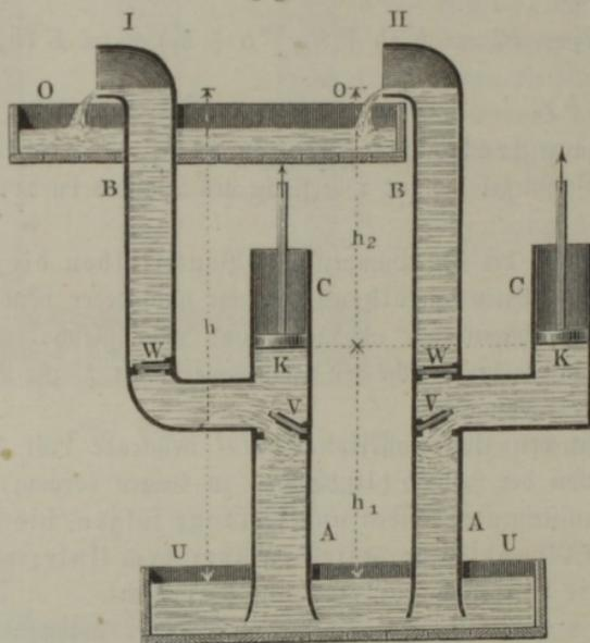
beim Niedergange desselben das erstere geschlossen und das letztere geöffnet. Im ersteren Falle wird der durch den Kolbenaufgang frei gewordene Raum der Kolbenröhre *C* vom Wasser angefüllt, welches der Atmosphärendruck mittelst der Saugröhre *A* zuführt, im zweiten Falle drückt der Kolben dieses Wasser aus dem Cylinder in die Steigröhre, und bewirkt dadurch den Ausguss einer gleichen Wassermenge in den Ausgusskasten *OO*.
