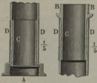
Seitenconvergenz *BCB* von 5 Grad. Der Widerstandscoefficient eines solchen Mundstückes ist bei mehrfachen Versuchen von dem Verfasser nicht größer als 0,03 gefunden worden; es wird also durch die Reibung des Wassers an der inneren Wand dieses Mundstückes die Steigehöhe des Strahles nur um 3 Proc. vermindert.
