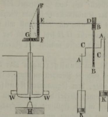
Eine einfache Radküst ist Fig. 653 skizzirt; W stellt das Wasserrad vor, CA den um C drehbaren Krummzapfen, AB die Kurbelstange, BD das Gestänge, und EF eine mittelst des Armes E an BD angeschlossene und
