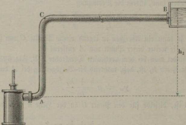
§. 145. **Druckwindkessel.** Man kann den Wassererschlag in den Druckröhren in jedem Falle gänzlich verhindern, wenn man in das Druckrohr möglichst nahe der Pumpe ebenfalls einen Luftbehälter, einen sogenannten Druckwindkessel, einschaltet, welcher durch die in ihm vorhandene Spannung  $h_2$  der Luft in dem Druckrohre ebenso eine nahezu gleichmäßige Bewegung des aufsteigenden Wassers unterhält, wie dies von dem Saugwind-
