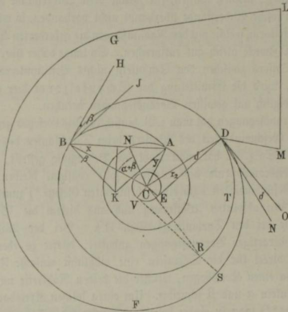
Kreises, welcher concentrisch zum Rade mit dem Halbmesser  $CE = r_2 \sin \delta$  beschrieben ist. Hierbei ist nämlich für jeden Punkt, z. B.  $R$ , im Umfange des Rades der zur Austrittsgeschwindigkeit des Wassers senkrechte Querschnitt des Gehäuses  $RS$  gleich demjenigen Austrittsquerschnitte des äußeren Radumfanges  $DTR$ , welcher das durch  $RS$  abzuführende Wasser liefert. Bezeichnet man nämlich den Winkel
