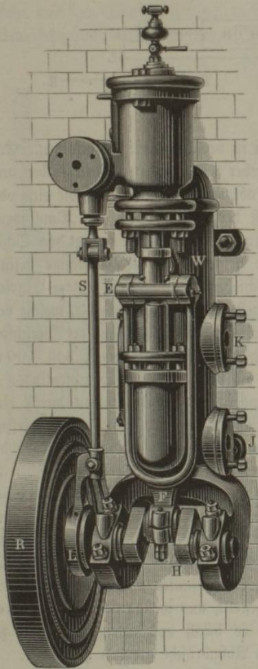
der Hub ist zu 144 mm gewählt, so daß das Verhältniß der Kolbenflächen  $\frac{F - f}{F} = 0,62$  und das vom Pumpenkolben durchlaufene Volumen  $\frac{\pi 0,59^2}{4} 1,44 = 0,3941$  beträgt.
