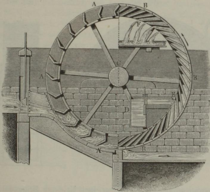
jede Abtheilung desselben bis ins Niveau der Nadage eine kleine Quantität Wasser mit empor und goß dasselbe in die hohle Welle, aus welcher es wieder durch andere Seitenöffnungen in einen Ausgußkasten geleitet wurde.
