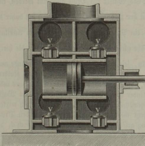
kolben direct durch eine gemeinschaftliche Kolbenstange verbunden, welche letztere mittelst der Kurbelschleife *F* eine mit dem Schwungrad *R* versehene Hilfsrotationswelle in der weiter unten bei den Dampfmaschinen besprochenen Weise bewegt. Der Durchmesser des Dampfkolbens beträgt 0,215 m, der des Pumpenkolbens 0,178 m und der gemeinschaftliche Hub 0,228 m, die Dampfspannung ist zu 7 Atmosphären Ueberdruck bemessen. Die Maschine beförderte bei
