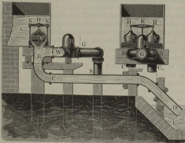
*SG* der obere Theil der Saugröhre, *R* ein Windkessel, und *BR* das vom letzteren nach der Leitungsröhre führende Communicationsrohr. Das Sperrventil des gewöhnlichen Stoßhebers ist hier durch das Eintrittsventil *V*, sowie das Steigventil des ersteren durch das Saugventil *W* ersetzt. Ist *V* er-
