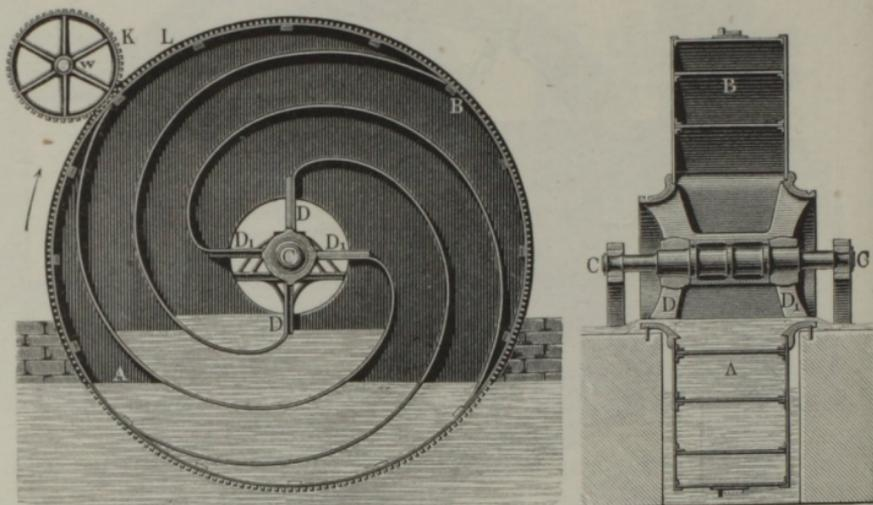
Kreisevolvente gekrümmten Spiralgänge, sowie die ebenen Seitenwände aus Eisenblech von 3 mm Stärke. Das Rad wird durch die Welle  $w$  und mittelst der Zahnräder  $K$  und  $L$  in langsame Umdrehung gesetzt, wobei das gehobene Wasser zu beiden Seiten durch die Räume zwischen den Armen und den dieselben umgebenden trichterförmigen Reifen ausgetragen wird.
