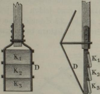
wie eine gewöhnliche Zugamme mittelst Zugleinen  $L$  in eine schwingende Bewegung gesetzt, wobei sie in der Minute 10 bis 12 Spiele macht, und 2,2 bis 2,6 cbm Wasser 1,2 m hoch empor schleudert. Damit die Schaufel  $D$  mit Leichtigkeit in das Unterwasser zurückgehe, versteht man dieselbe mit nach oben sich öffnenden Klappen  $K_1, K_2, K_3$ , Fig. 552, von 0,5 m Länge und je 0,2 m Breite, und umgibt sie mit einem
