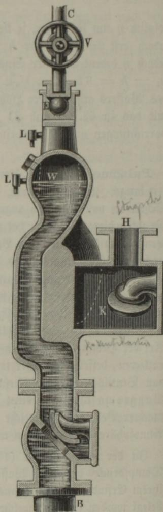
mit dem Saugrohre  $B$ , oben mit der Dampfzuleitung  $C$  in Verbindung steht, in welcher letzteren das Absperrventil  $V$  gewöhnlicher Einrichtung angebracht ist, um die Zuführung des Dampfes reguliren zu können. Der Abschluß der Kammern  $A$  gegen das Saugrohr wird durch zwei Gummiflappen, früher Kugelventile,  $S_1$  und  $S_2$  bewirkt, welche ähnlich den Saugventilen einer doppelwirkenden Pumpe abwechselnd geöffnet und geschlossen
