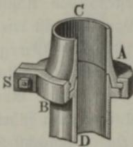
direct ohne Naht gewebt. Die Art und Weise, wie die Schläuche durch Schrauben verbunden werden, ist aus den Abbildungen in Fig. 645 I und II zu ersehen. Es läuft sowohl die Mutter *A*, Fig. I, wie die Schraube *BB*, Fig. II, in eine kurze cylindrische Messingröhre *C* aus, über welche das Schlauchende *DD* weggezogen und worauf es durch eine umgewickelte Schnur befestigt wird.
