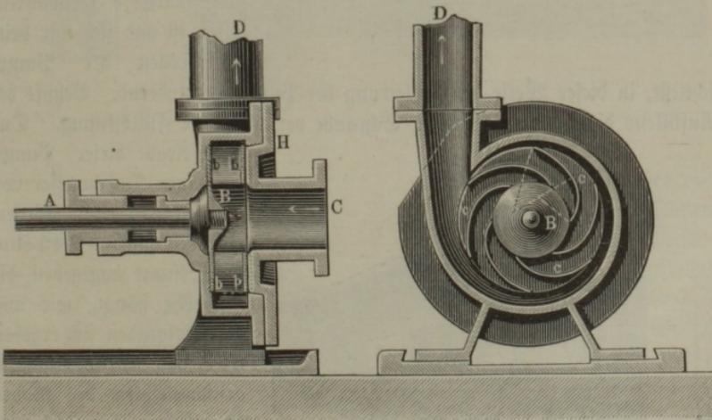
und sechs zwischen denselben befindlichen Schaufeln *c* bestehende Kreisrad *B* befestigt, welches sich in dem spiralförmig gestalteten gußeisernen Gehäuse *H* mit 1500 bis 2000 Umdrehungen in der Minute dreht. Das durch die Saugröhre *C* aufsteigende Wasser tritt dem Rade in dessen Mitte zu, und wird von den Schaufeln ergriffen und nach außen getrieben, wo es, durch
