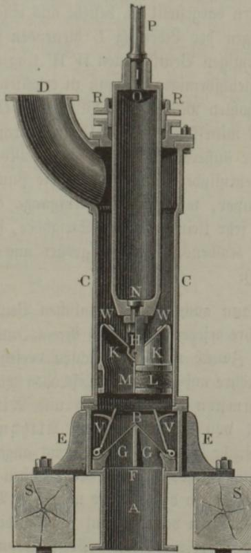
nöthig ist, Reparaturen an denselben vornehmen zu können, ist über der Kolbenröhre ein zweites Gehäuse *D* mit einer Seitenöffnung angebracht, welche ebenfalls durch eine Eisenplatte *T* verschlossen wird. Das untere Ende der Saugröhre ist birnförmig erweitert und zum Abhalten von Unreinigkeiten mit vielen feinen Eintrittslöchern versehen.
