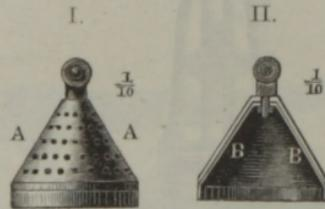
lichen Ventilkolbens, theils darin, daß hier das Wasser von oben in den Cylinder eintritt und nach unten in den Windkessel gedrückt wird. Was den Letestu'schen Kolben anlangt, so besteht derselbe aus einem durchlöchernten Blechtrichter *A*, Fig. 637 I., und einem denselben von innen
