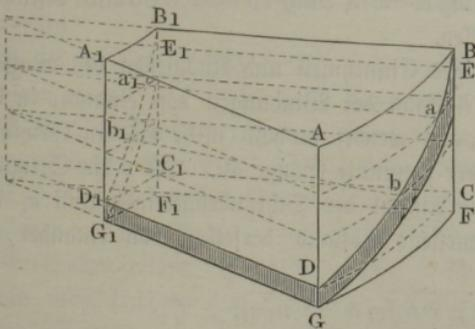
Basis  $AB_1 = CD_1$  ein Kreissector ist, welcher die Projection einer Schaufel rechtwinkelig gegen die Schraubenaxe darstellt. Zeichnet man sich nun auf die beiden cylindrischen Stirnflächen  $AC$  und  $A_1C_1$  dieses Körpers die Schraubenlinien  $BD$  und  $B_1D_1$  auf, und führt man einen Sägeschnitt
