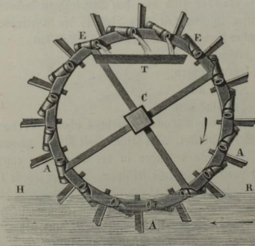
Das sogenannte fränkische Schöpfrad, wie es an der Mednitz bei Erlangen angewendet wird, zeigt Fig. 557. Es ist dies ein im freien Ströme hängendes Streberad *ACB*, an dessen Kränzen kegelförmige Eimer oder Kübel *E, E*.. so befestigt
