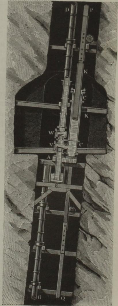
Der Wirkungsgrad  $\eta = \eta_1 \eta_2$  der ganzen Maschine ist hier ein Product aus dem Wirkungsgrade  $\eta_1$  der Wasserfäulenmaschine und aus dem Wirkungsgrade  $\eta_2$  des Pumpenwerkes; ist folglich  $Q$  das Ausschlagwasserquantum,  $h$  das Wasserfäulengefälle und sind wieder  $Q_1, Q_2 \dots$  die durch die Pumpen auf die Höhen  $h_1, h_2 \dots$  zu hebenden Wassermengen, so kann man setzen:
