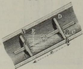
Das Wasservolumen *V* läßt sich in der Regel als ein prismatischer Körper berechnen. Bei der Schaufelkunst hängt dieses Volumen vorzüglich von der Neigung derselben gegen den Horizont ab. Bezeichnet *a* die Höhe *AH*, Fig. 572, einer Schaufel, ferner *b* die Breite derselben und *c* den Abstand *AB* je zweier Schaufeln von ein-
