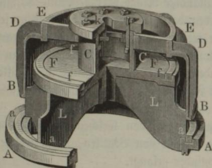
abzudrehen, auch läßt man wohl die Ventile auf besondere, aus Holz oder einem weicheren Metalle bestehende Ringe *a* und *f* aufschlagen. — Die Flügel *L* dienen dem Teller *F* als Stütze und dem Ventile zur Leitung. Den letzteren Zweck hat aber auch der auf *F* sitzende Cylinder *C*, welchen das Ventil mittelst eines Ringes umfaßt, und die
