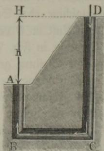
Luft nimmt stets eine Bewegung an, wenn dieselbe eine andere Temperatur hat als die äußere Luft, und wenn die Mündungen  $A$  und  $D$ , wo diese Röhre mit äußerer Luft communicirt, nicht in demselben Niveau liegen. Ist  $h$  der senkrechte Abstand  $AH$  zwischen den Mündungen  $A$  und  $D$ ,  $t$  die äußere und  $t_1$  die innere Lufttemperatur, so kann man nach Thl. II, (Theorie der Essen), die theoretische Geschwindigkeit der Luft bei  $D$  entweder
