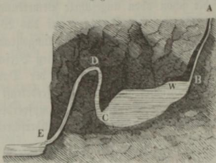
Ein gemauerter kurzer Heber dieser Art ist bereits in Band II, wo vom Reguliren des Wasserstandes in einem Canale die Rede ist, abgehandelt worden. Auch gehören hierher jedenfalls die sogenannten intermittirenden Quellen, wie *ABCDE*, Fig. 733.
