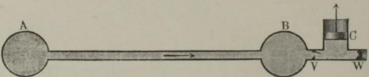
Bezeichnen  $p$ ,  $\gamma$  und  $t$  die Spannung, Dichtigkeit und Temperatur der Luft in *A* sowie  $p_1$ ,  $\gamma_1$  und  $t_1$  dieselben Größen für die Luft in *B*, so hat man nach dem Gesetze von Mariotte und Gay-Lussac (Thl. I, Abschn. VI, Cap. 4)
