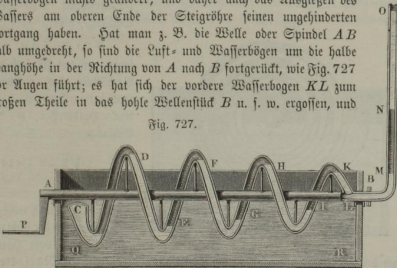
es ist von dem hornförmigen Einmündungsstücke *C* ein neuer Wasserbogen gefaßt worden.
