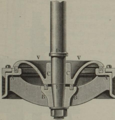
Fig. 603. Der Kolbenstock *A* ist hier ähnlich geformt wie bei dem Kolben in Fig. 602; aber das Ventil *V* besteht hier aus einem gußeisernen Teller und ist mittelst einer Hülse *C* auf dem abgedrehten Theile *DE* der Kolbenstange bis zum Anlaufe *D* verschiebbar. Den Abschluß bewirken zwei in den Kolbenstock eingesetzte Messingringe *aa* und *bb*, auf welche der Ventilteller aufgeschliffen ist.
