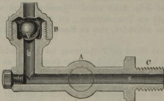
die Kugel wieder in ihren unteren Sitz zurückfällt. Beim darauf folgenden Kolbenniedergange hebt sich die Kugel von Neuem und gelangt so in eine schwingende Bewegung, welche so lange anhält, bis sich die Röhre *cb* mit Wasser anfüllt, welches dann die Kugel während des ganzen Kolbenspieles gegen ihren oberen Sitz andrückt.
