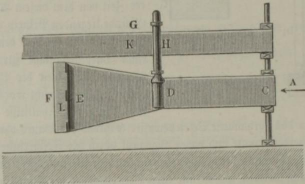
vollständig erreicht, indem die etwa 24,3 m lange, 5,6 m breite Baugrube in der Zeit von einer halben Stunde auf 2,4 m Tiefe entleert und fortwährend von Wasser freigehalten wurde. Es muß dabei bemerkt werden, daß der Apparat nach Angabe unserer Quelle noch richtig functionirte, wenn auch die Saughöhe beträchtlich größer (1,8 — 2,4 m) ausfiel, als die Gefällshöhe.
