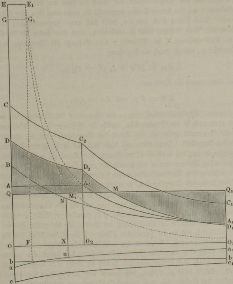
und eine widerstehende Arbeit auf die Rückfläche des kleinen Kolbens ausübt. Diese Arbeiten zu bestimmen, sei bemerkt, daß die Spannung dieses Dampfes zu Anfang gleich  $p_1$ , also der treibende Druck auf den großen Kolben gleich  $OB = Fp_1$  und der hindernde Druck auf den kleinen Kolben gleich  $Oa = f_1 p_1$  ist. Zu Ende des Hubes hat dieser Dampf aus dem Volumen  $f_1 L$  in dasjenige  $FL$ , also im Verhältniß  $\frac{F}{f_1} = \varphi$  sich ausge-
