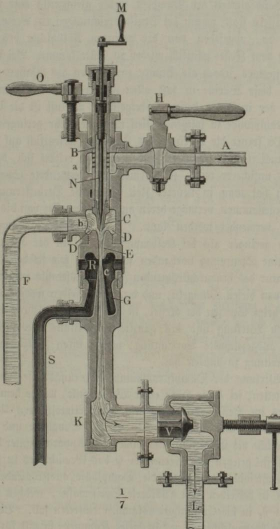
während durch eine andere Schraube *O* die Röhre *BC* verschoben werden kann, um hierdurch den ringförmigen Zwischenraum genau zu reguliren, welcher zwischen der Dampfdüse *C* und dem Boden der Kammer *D* dem Speisewasser den Zutritt gestattet. Das von der Auffangdüse *G* nicht auf-
