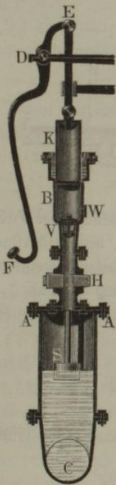
außen beobachtet werden kann; ferner ist *B* der durch ein engeres Communicationsrohr mit dem Recipienten in Verbindung stehende Pumpencylinder, *K* der in demselben spielende Kolben und endlich *EDF* der um *D* drehbare Hebel, wodurch der Kolben in *B* auf- und niederbewegt wird. Noch sieht man bei *V* das Saug- und bei *W* das Ausblaseventil, sowie in *H* einen kleinen Hahn, wodurch man zur Erzielung eines dichteren Abschlusses den ganzen Pumpenapparat vom Luftrecipienten *ACA* absperren kann.
