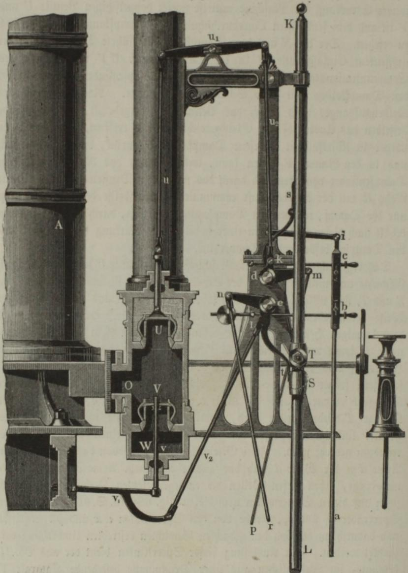
mittelft der an dieser Stange sitzenden Bolzen  $b$  und  $c$ , Fig. 686, die eine oder die andere der Sperrklinken  $yz$  und  $xw$  aus den Sperrrädern  $e_1$  und  $d_1$  ausgelöst wird. Das Steuerungsspiel geht nun mit Hilfe des Katarakts auf folgende Weise vor sich. Der Dampfkolben und also auch das Schacht-
