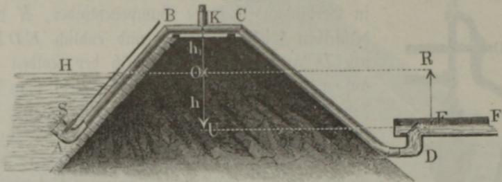
spiegels  $H$  über dem Unterwasserspiegel,  $l$  die ganze Axenlänge des Hebers,  $d$  die Weite desselben,  $v$  die Ausflußgeschwindigkeit,  $\xi_0$  den Widerstandscoefficienten für den Eintritt des Wassers bei  $A$ ,  $\xi$  den Reibungscoefficienten für die Bewegung des Wassers in dem Heber, und sind  $\xi_1$  und  $\xi_2$  die Widerstandscoefficienten für den Durchgang des Wassers durch die Krümmungen  $B$  und  $C$ , so hat man:
