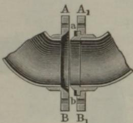
Kupferringen bekleidet. Kupferne Saugröhren erhalten in der Mitte ein Gelenk wie *AB*, Fig. 641, welches im Inneren mit einem Lederringe *ab* abgedichtet ist und dazu dient, die Richtung des Wasserstromes nach Bedürfniß abzuändern. Die Einmündung des nach Befinden aus mehreren solchen Schläuchen
