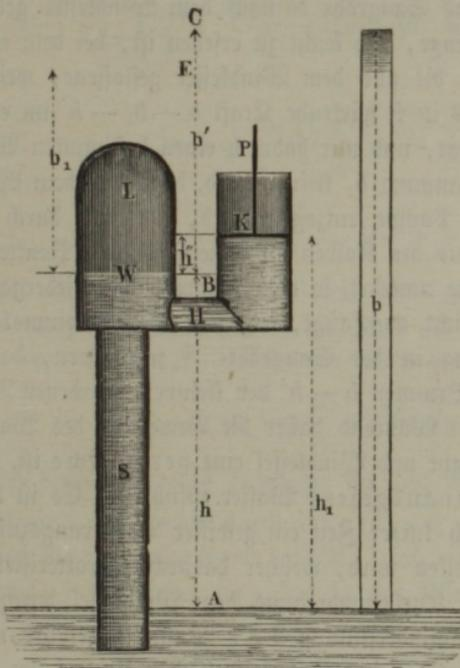
hälter W eingeschaltet, welcher in L ein bestimmtes Luftquantum enthält, so ist zunächst klar, daß im Stillstande der Pumpe die Spannung dieser Luft um die Höhe  $AB = h'$  kleiner sein muß, als diejenige der äußeren Atmosphäre, welche letztere durch eine Wassersäule von der Höhe  $AC = b$  dargestellt sein mag. Bezeichnet ebenso  $b_1$  die Wasserbarometerhöhe der in dem Windkessel enthaltenen Luft, so hat man also für den Zustand der Ruhe
