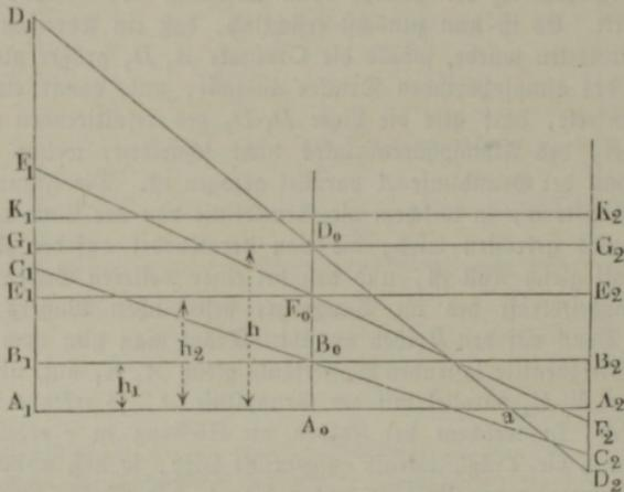
wird. Auch hier stellt  $A_1 A_2 = 2r$  die Grundlinie vor, und die Parallelen  $B_1 B_2$  und  $E_1 E_2$  sind in Abständen  $A_1 B_1 = h_1$  und  $A_1 E_1 = h_2$  von der Basis gezogen. Zeichnet man in derselben Weise die geraden Linien  $C_1 C_2$  und  $F_1 F_2$  für die Beschleunigungskräfte des Wassers in dem Saugrohre und in dem Steigrohre, so daß
