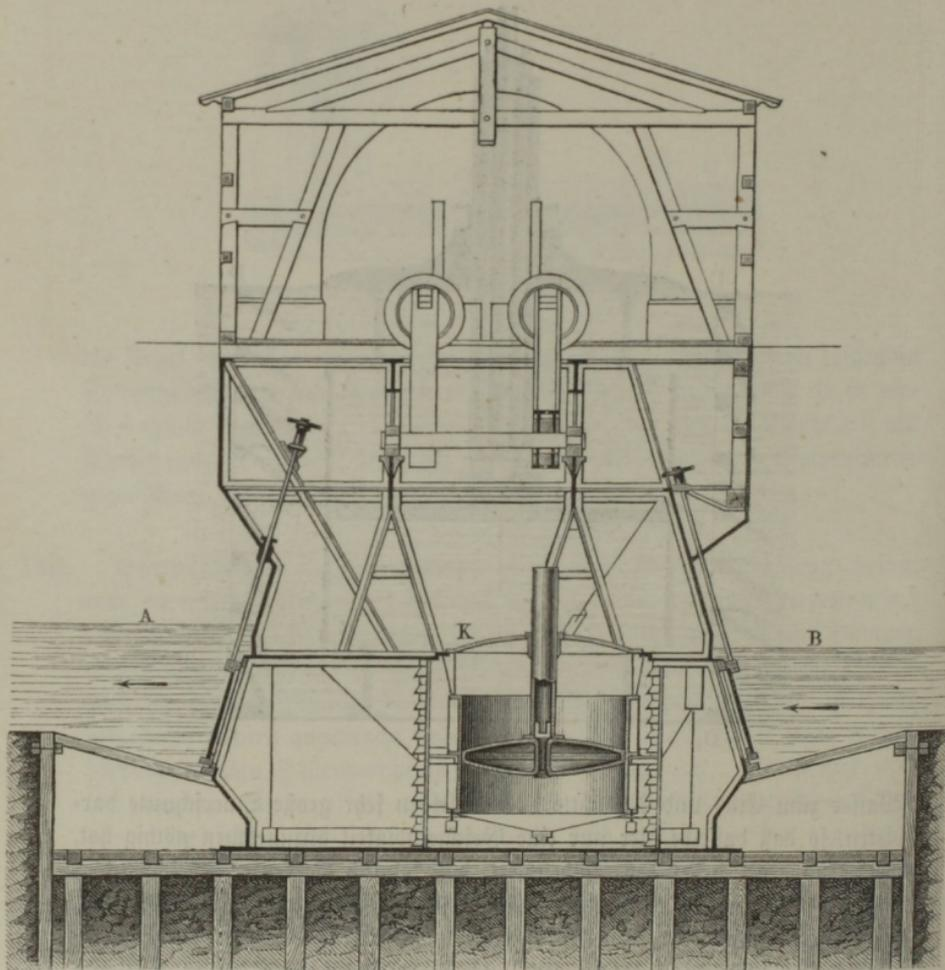
daß die Aenderung der Wasserstände hierauf einen Einfluß hat. Zu dem Ende wird nämlich der Pumpenkasten  $K$  in einer Durchbrechung des Deiches, welcher die zu entwässernde Niederung einschließt, so tief aufgestellt, daß der niedrigste Binnenwasserstand  $B$  noch über den Ventilen gelegen ist. Hierdurch wird jede unnöthige Hebung des Wassers vermieden, welche bei einer gewöhnlichen Pumpen-
