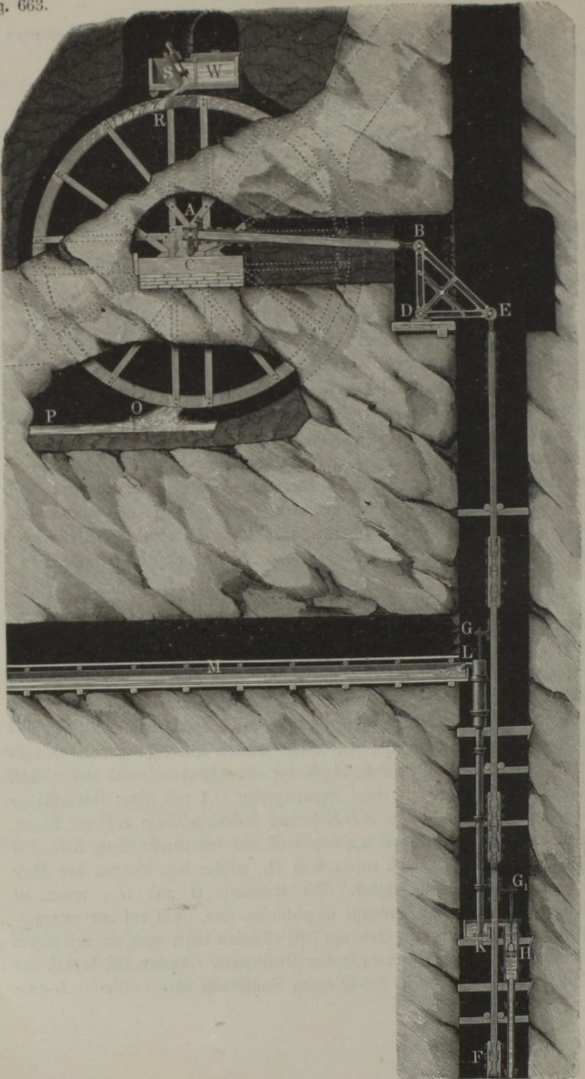
gegossenen Subwasser fließen auf dem Stolln  $M$  sowie die Aufschlagwasser nach vollbrachter Wirkung auf der Rösche  $P$  ab. Bei dieser Maschinenanlage befindet sich zwischen der Abzugsrösche und dem Stolln noch ein freies, für andere Zwecke verwendbares Gefälle, da die Aufschlagwasser mit den Subwassern zugleich auf dem Stolln abgeführt werden können.
