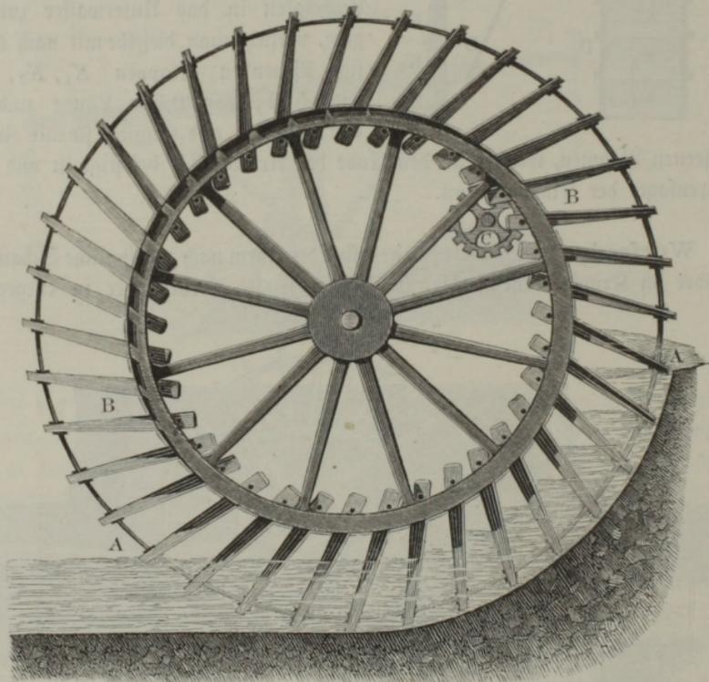
am Boden als auch an den Seiten des Kropfes einen Spielraum von 25 mm, und heben das Wasser 1 bis 1,2 m hoch. Die vier Arme *A, B, C, D*
