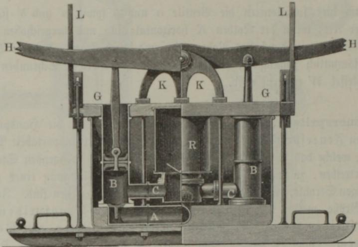
sogenannte Schlittenspritze, wird jedoch gewöhnlich auf einem Karren oder Wagen transportirt. Fig. 633 zeigt zur Hälfte den Längenschnitt und zur
