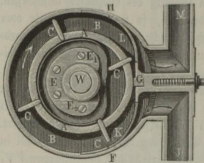
ist der Abflachung der Scheibe *E* zwischen *E*<sub>1</sub> und *E*<sub>2</sub> gegenüber eine Leitschiene *FGH* eingesetzt, von solcher Form, daß der betreffende Curvencanal an allen Stellen in radialer Richtung eine Breite gleich derjenigen der Schieber *C* hat. Es ist sonach leicht ersichtlich, wie bei einer Umdrehung der Welle *W* mit dem Kranze *A* in der Richtung des Pfeiles die Schieber auf dem Wege von *H*
