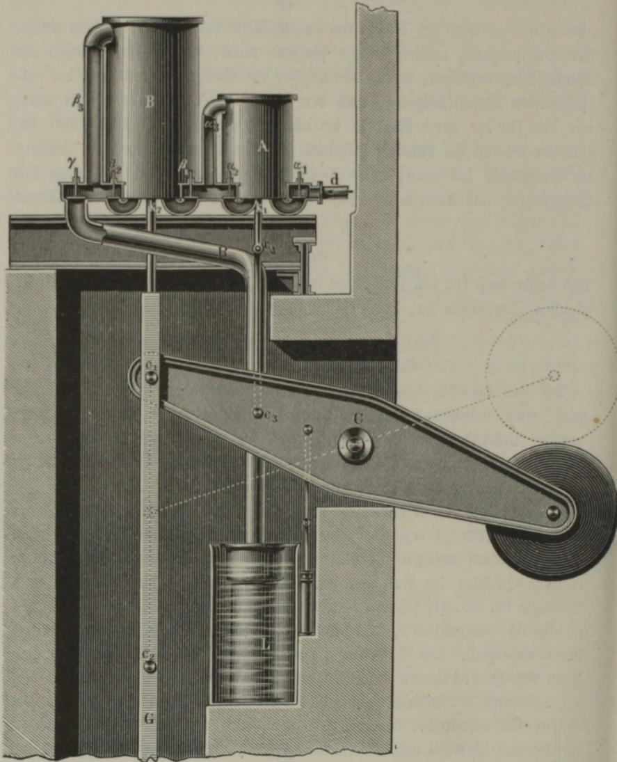
Dampfcylinder *A* und *B* sind so neben einander über dem Schachte aufgestellt, daß das Gestänge *G* direct an die Kolbenstange *k<sub>2</sub>* des großen Cylinders *B* angeschlossen ist. Das Gestänge drückt, wie üblich, durch sein Gewicht beim Nieder sinken das Wasser der Druckpumpen empor, und es ist
