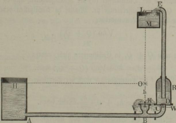
Ausmündung  $K$  des Sperrventiles gemessen, und  $h_1$  die Förderhöhe  $OL$ , von eben diesem Wasserspiegel bis zur Ausgüßmündung  $E$  gerechnet, so ist der Wirkungsgrad des Stoßhebers:
