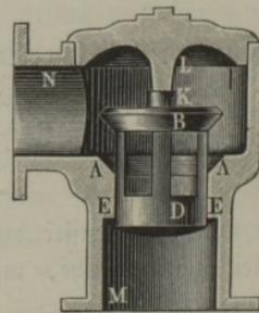
Ventilsitz,  $B$  die conische Ventilplatte, ferner  $M$  das Rohr, wodurch das Wasser dem Ventil zugeführt wird, und  $N$  die Ventilkammer oder das Ventilgehäuse. Damit sich das Ventil genau in seiner geometrischen Axe ausschieben könne, wird es entweder mit einem Stiel  $CD$ , Fig. 590,
