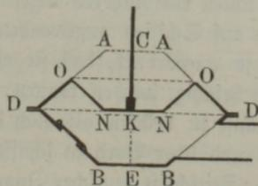
Halbmesser der Grundflächen *AA* und *DD* und ist  $h$  die Höhe  $CK = EK$  eines solchen Kegels, also der Kolbenhub  $s = 2h$ , so hat man folglich das theoretische Wasserquantum, welches eine solche Pumpe pro Spiel liefert:
