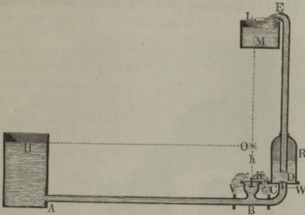
Windkessel durch ein sich nach oben öffnendes Ventil *W*, das sogenannte Steigventil, dagegen die kurze Seitenröhre *BK* mit einem sich nach unten öffnenden Ventil, dem sogenannten Sperrventil *V*, versehen.
