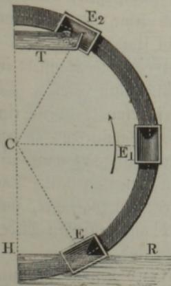
zusammengesetzten Kästen gehoben wird, und zwar entweder mit schrägen Axen, wie Fig. 556, oder mit der Axenstellung wie Fig. 557. Diese Kästen sind dann auch in der Regel von allen Seiten umschlossen und haben nur eine Seitenöffnung zum Einschöpfen und Ausgießen des Wassers, wie Fig. 558 vor Augen führt, wo, Fig. 557 entsprechend, *E* einen einschöpfenden, *E<sub>1</sub>* einen steigenden und *E<sub>2</sub>* einen ausgießenden Schöpfkasten bezeichnet.
