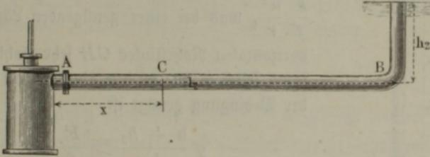
Pumpe, Fig. 622, mit horizontaler Druckröhre  $AB$  von der Länge  $l_2$  ist die Verzögerung für den Punkt  $A$  an der Pumpe durch
