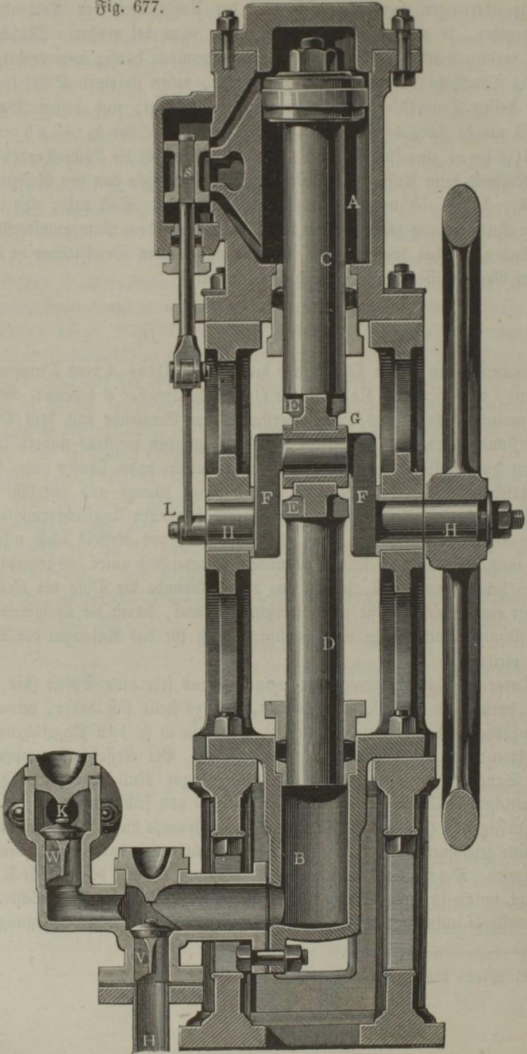
Dampfvertheilungsschiebers *S* übernimmt. Der Durchmesser des Dampfkolbens beträgt hier 105 mm, der Kolbenstange 65 mm, des Plungers 59 mm und
