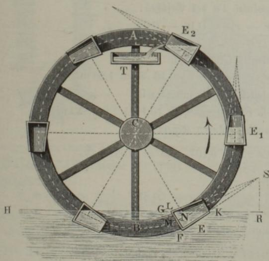
Falle aus der Zeichnung oder durch Rechnung gesehen können. Es ist z. B. bei einem Schöpfrade mit kegelförmigen Eimern, Fig. 565, dieses Wasservolumen die Differenz zwischen einem Kegelförmigen Basen  $FG$  und einem Keil  $KLS$  mit elliptischer Basis. Ist  $s$  die Höhe  $SM$  und  $\alpha$  der halbe Convergenzwinkel  $FSM = GSM$  des einen Kegels, so hat man dessen Volumen:
