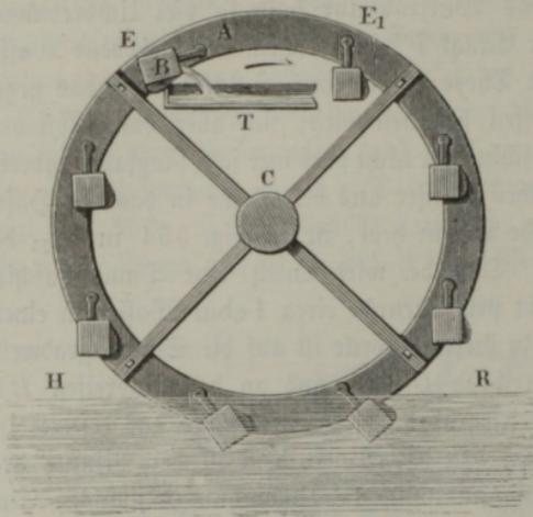
die selben aus Bambusrohr) emporgehoben, welche schräg auf dem Radfranze befestigt sind. Die Bewegung dieses Rades erfolgt durch die Strömung des Wassers *HR*, indem dasselbe auf die Schaufeln *A* schlägt, welche, wie bei einem gewöhnlichen Streberade, mittelst Stielen an den äußeren Umfang des Radfranzes angefügt sind. Das oben ausge-
