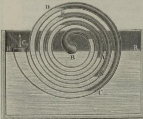
Wasserbogen  $CC_1$  von nur einem Quadranten Länge ein, der allerdings bei weiterer Umdrehung, wie wieder in Fig. 728 zu ersehen ist, die halbe äußerste Schlangenwindung  $DE$  ausfüllt. Man muß zur Erfüllung dieser Bedingung fordern, daß der Wasserspiegel  $HR$  ein wenig unter der Wellenaxe stehe, und der mittlere Querschnitt  $\pi q_0^2$  des Hornes gleich sei dem doppelten Querschnitt  $\pi q^2$  der Schlange, also
