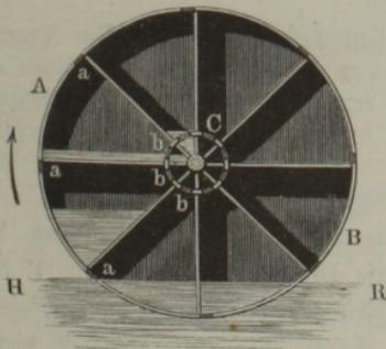
ren, welche das Wasser von dem äußeren Umfange nach dem Inneren der Welle führen, wogegen das Rad von Perronet mit spiralförmigen Scheidewänden ausgerüstet und an den Seiten mit ebenen Wänden bekleidet ist.
