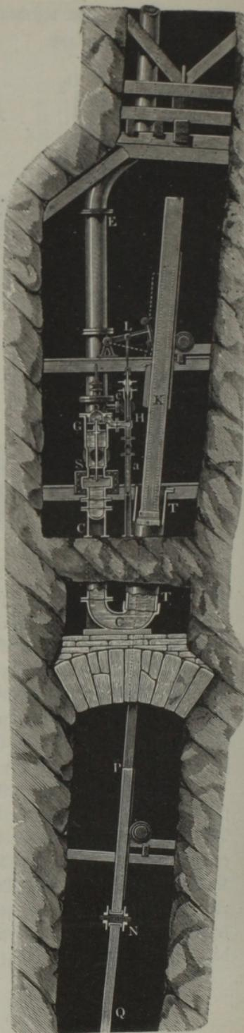
und *W* geöffnet ist, wird das Wasser im Steigrohre *WD* emporgedrückt, geht hingegen der Kolben *K* aufwärts, so öffnet sich *V* und schließt sich *W*, und es wird neues Wasser mittelst des Saugrohres *SV* aus dem Saugfaßen *S* angesaugt, welcher seinen Zufluß aus der Steigrohre *AB* des nächst tieferen Druckfaßes erhält.
