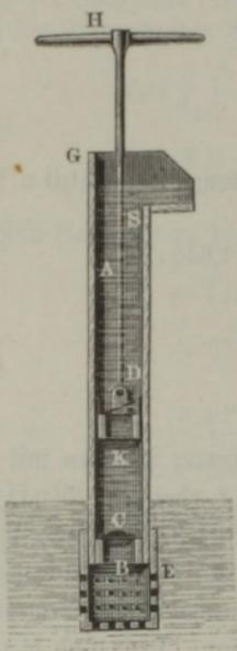
Da die Kraftäußerung eines Menschen bei dem Niederdrücken eine vortheilhaftere ist als beim Aufziehen, so richtet man den Pumpenhebel so vor, daß derselbe vorzüglich nur eine Kraft zum Abwärtsdrücken oder Abwärtsziehen erfordert. Deshalb ist derselbe in der Regel bei Saugpumpen ein doppel- und bei Druckpumpen ein einarmiger Hebel.
