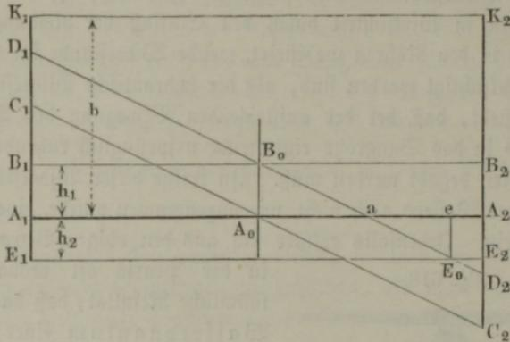
und in dem Abstände  $A_1 B_1 = h_1$  eine Parallele  $B_1 B_2$  mit der Axe gezogen. Dann kann man die constanten Ordinaten zwischen  $A_1 A_2$  und  $B_1 B_2$  als die Belastung des Kolbens durch die an demselben hängende Wasserfäule im Saugrohre ansehen. Denkt man sich nunmehr die zur Beschleunigung  $\frac{F}{f} \frac{u^2}{r} \cos \alpha$  des Wassers in dem Saugrohre erforderliche Kraft durch das Gewicht einer Wasserfäule von der Höhe  $x$  ausgedrückt, so bestimmt sich  $x$  durch
