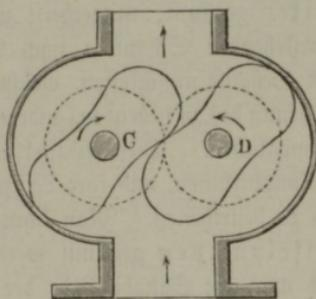
die äußeren zur Bewegungsübertragung dienenden Stirnräder nicht entbehrt werden können; dasselbe gilt auch von der durch Fig. 708 dargestellten Form dieser Pumpe, deren Wirkungsweise nach dem Vorstehenden einer besonderen Erläuterung nicht bedarf.
