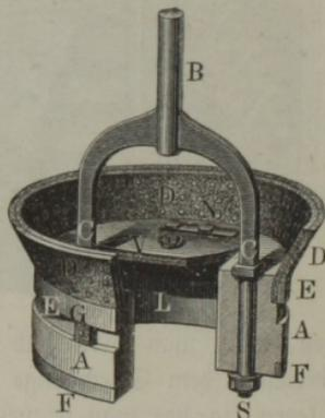
besteht entweder aus Buchenholz, welches vorher in Del gekocht wird, oder er wird aus Eisen oder Bronze gegossen. Die Liderung besteht bei den
