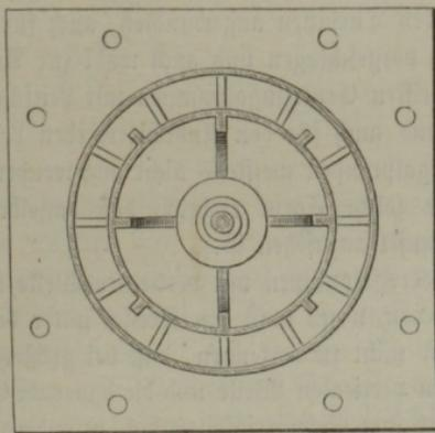
Rohr *C*, an welches das Saugrohr angeschlossen wird, zu einem gabelförmigen Canale *E* gestaltet ist, welcher dem Rade das Wasser zu beiden Seiten zuführt. Dabei ist der Deckel *F* zweckmäßig so gestaltet, daß derselbe behufs des Zugangs zum Innern leicht abgenommen werden kann, ohne das Gehäuse *H* von seinem Fundamente oder das Saugrohr vom Gehäuse entfernen zu müssen.
