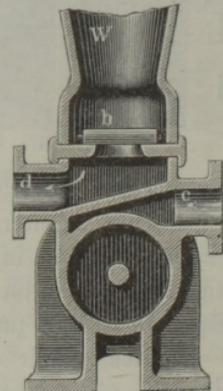
der Ventile, um etwaige Störungen in deren Spiel, wie sie durch Verunreinigung leicht vorkommen, schnell beseitigen zu können. Als eine musterhafte Construction kann in dieser Beziehung die sogenannte California-Pumpe, zuerst von Hansbrow eingeführt, angesehen werden. Eine derartige, von Werner \*) verbesserte Construction zeigen die Figuren 631 und 632.
