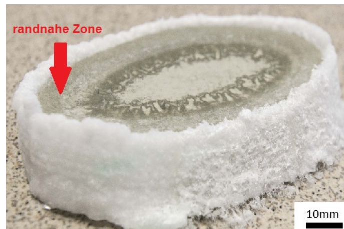
Abbildung 4.59: Gussform aus Natriumacetat-Trihydrat mit erstarrtem Beton (Quelle: Eigene Darstellung)
