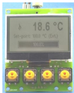
Abbildung 4.35: Display Typ QC-PC-D-CH1 (Quelle: Fa. Quickcool GmbH (2017))
