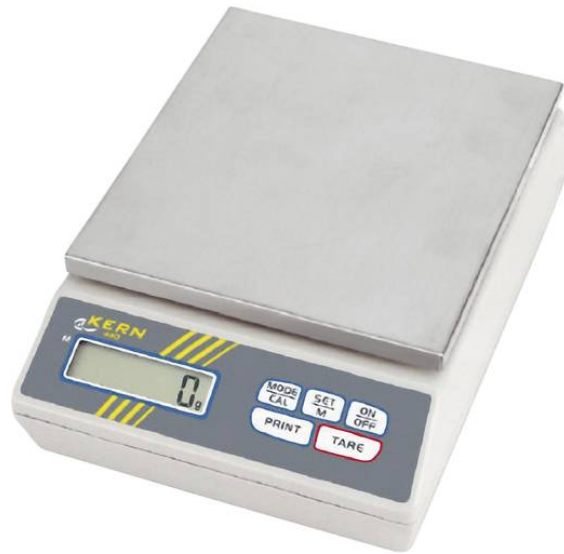
Abbildung 4.26: Präzisionswaage PCB 1000-2 (Quelle: Fa. Kern und Sohn GmbH (2017))
