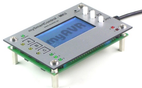
Abbildung 4.36: Microcontroller Typ mySmartControl MK3 (Quelle: Fa. myAVR GmbH (2017))
