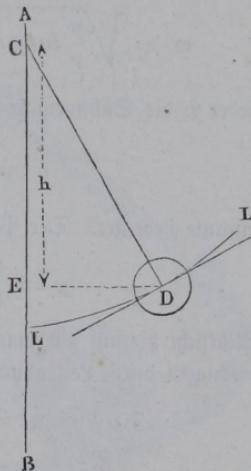
des Pendelarmes zwischen der Kugelmittle und der Spindel  $AB$  zu verstehen. Denkt man sich nun die Kugel, anstatt an dem festen Punkte  $C$  hängend, auf einer gewissen Leitcurve  $LL$ , Fig. 767, geführt, so wird die Wirkung des früheren festen Aufhängepunktes  $C$  nunmehr durch die in  $D$  zur Curve normale Reaction  $DC$  ersetzt. Es gilt daher dieselbe Rechnung, wie sie in §. 195 für das Centrifugalpendel angeführt wurde, und man hat wie dort die
