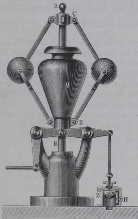
geschehen und neuerdings sehr beliebt geworden. Bei der Aufhängungsart des Porter'schen Regulators, wo die Kugeln in den Angriffspunkten der Hülsenstangen befindlich sind, hat man  $l = l_1$  und daher
