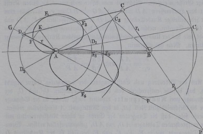
gegeben sind, unter  $r$  und  $r_1$  die Kurbellängen  $AD$  und  $BC$  verstanden, so folgt aus diesen Beziehungen einfach
